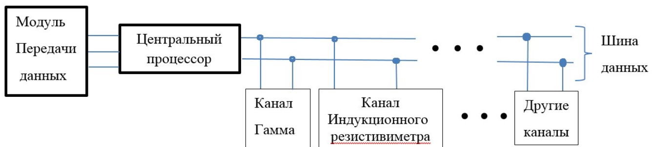
Рисунок 19 – Архитектура скважинной аппаратуры для объединенной КНБК
