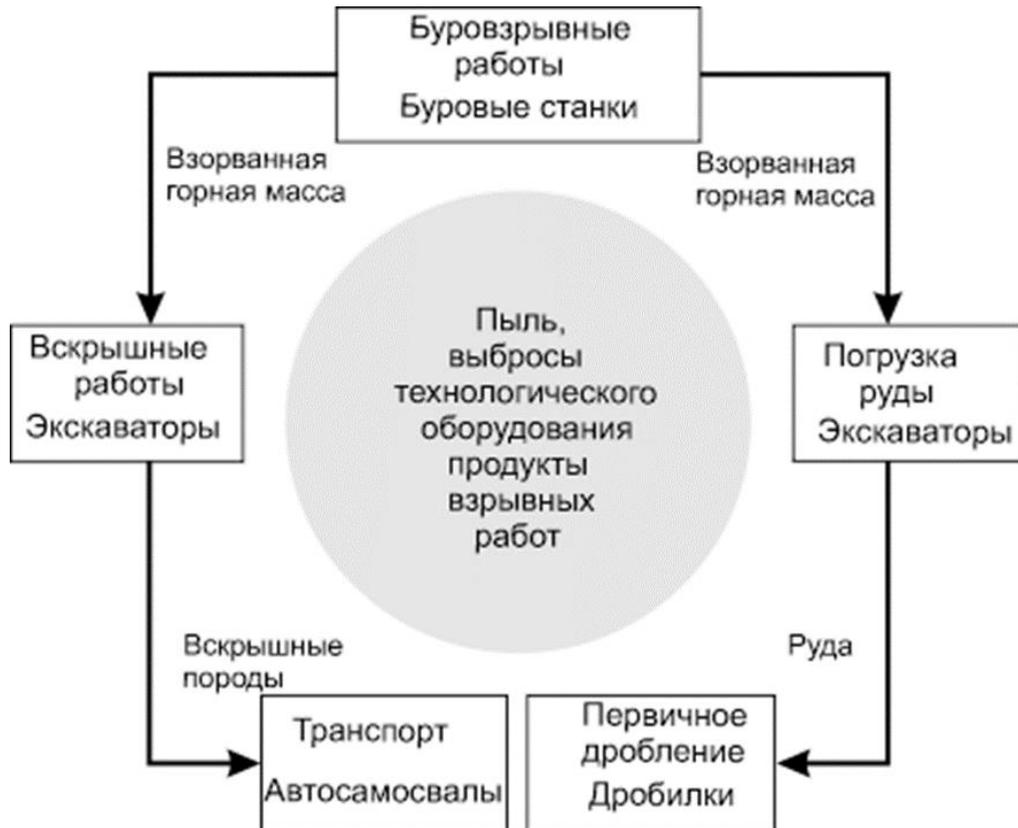
Рисунок 2.5 – Блок-схема процессов открытых горных работ
