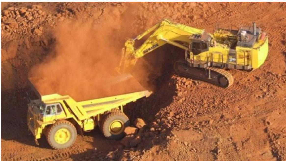
Рисунок 2.10 – Облако пыли при разгрузке ковша в кузов самосвала
