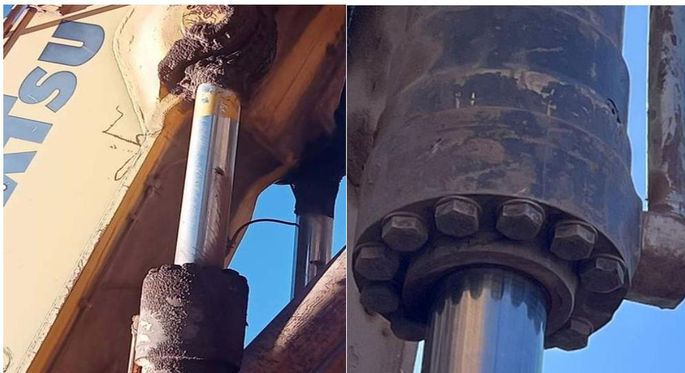
Рисунок 4.17 – Состояние гидроцилиндров экскаваторов Komatsu PC1250-7 и Liebherr R9100 G6 на руднике Бухадра
