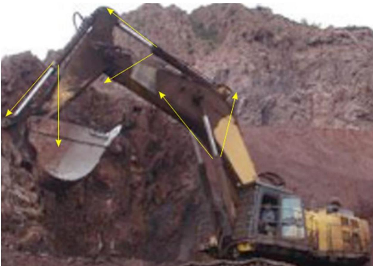
Рисунок 4.21 – Пример предельного изнашивания уплотнений штоков силовых гидроцилиндров экскаватора. Выбросы гидравлической жидкости на стреле, рукояти и ковше, покрытые железорудной пылью
