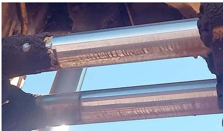
Рисунок 4.20 – Предельное изнашивание уплотнений штоков силовых гидроцилиндров экскаватора приводит к изнашиванию штока при трении о крышку гидроцилиндра
