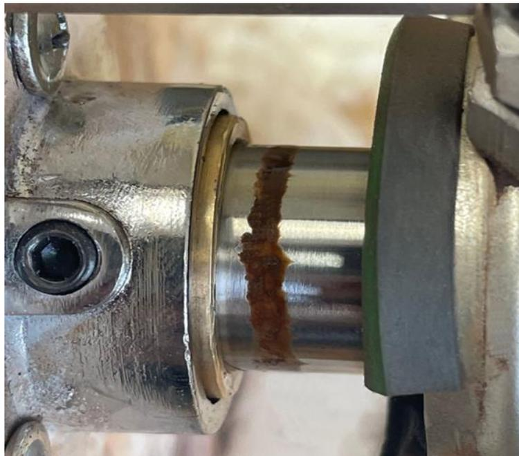
Рисунок 4.11 – Пропуск гидравлической жидкости вдоль штока, загрязненной железорудной пылью после изнашивания грязесъемника и уплотнения
