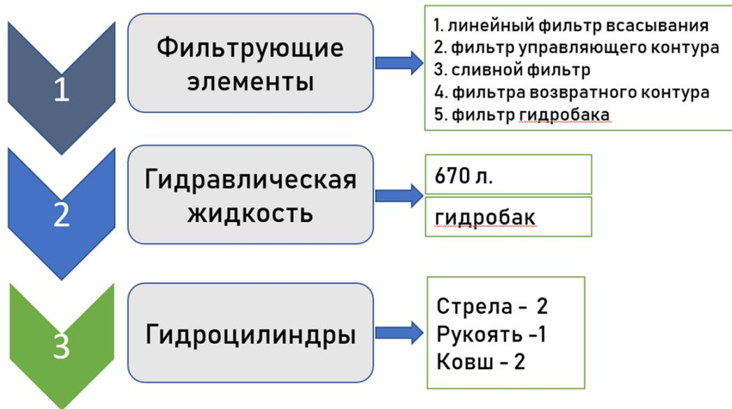
Рисунок 4.18 – Схема разукрупнения элементов гидросистемы
