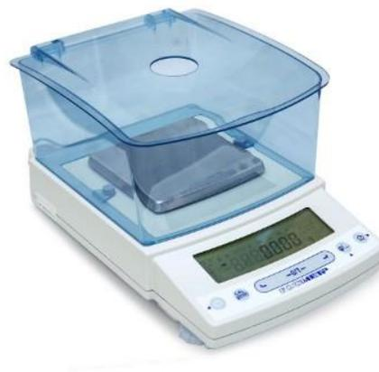
Рисунок 3.1 – Весы лабораторные ГОСМЕТР ВЛЭ-423С, самокалибровка
