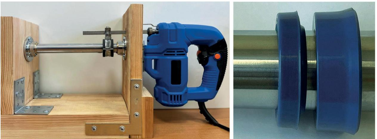
Рисунок 3.6 – Внешний вид лабораторного трибо-стенда; установка грязесъемника и уплотнения на штоке
