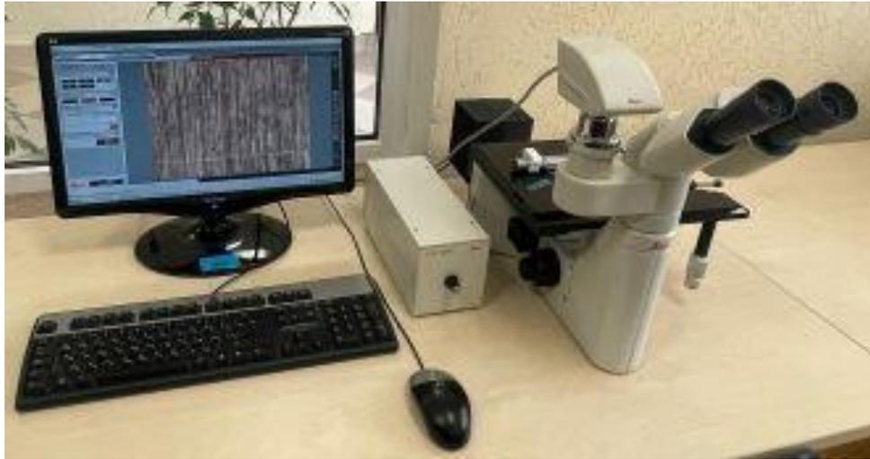
Рисунок 3.10 – Металлографический инвертированный микроскоп Leica DM ILM HS
