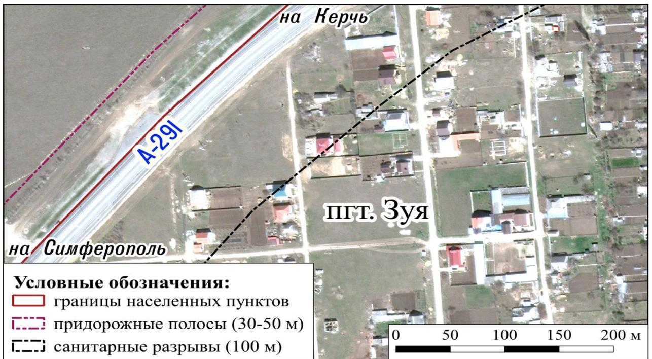
Рисунок 2.41 – Фактическое расположение придорожных полос и санитарных разрывов в пгт. Зуя
