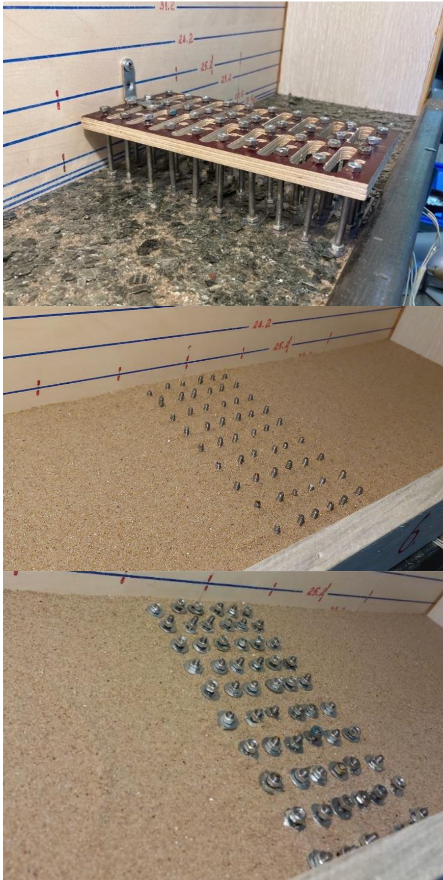
Рисунок 3.9 – Процесс установки анкеров
