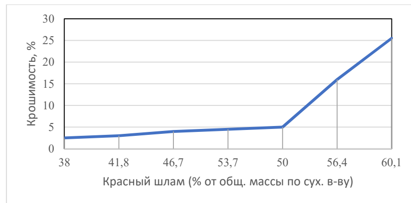
Рисунок 4.4 - Влияние содержания красного шлама на крошимость гранул
