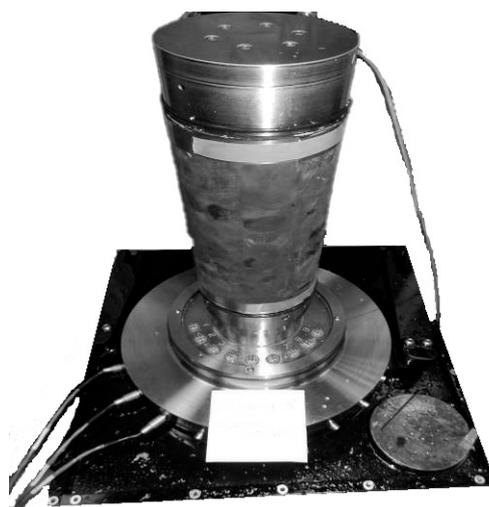
Рисунок 2.3 - Образец горной породы, подготовленный к испытаниям в трехосной камере
