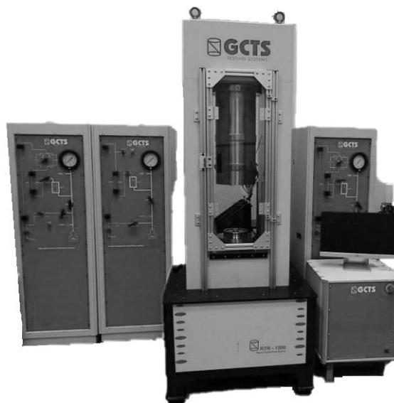
Рисунок 2.2 - Вид сервогидравлической установки
