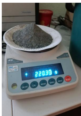
Рисунок 3.1 – Контрольно-измерительный прибор – весы AND DL-5000
