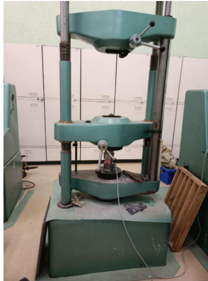
Рисунок 3.11 – Испытательная машина ДРМБ-300 с установленным экспериментальным образцом
