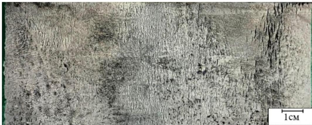
Рисунок 3.8 – Фотография зоны КРН фрагмента №3(10П) после проведения магнитопорошкового контроля [86]
