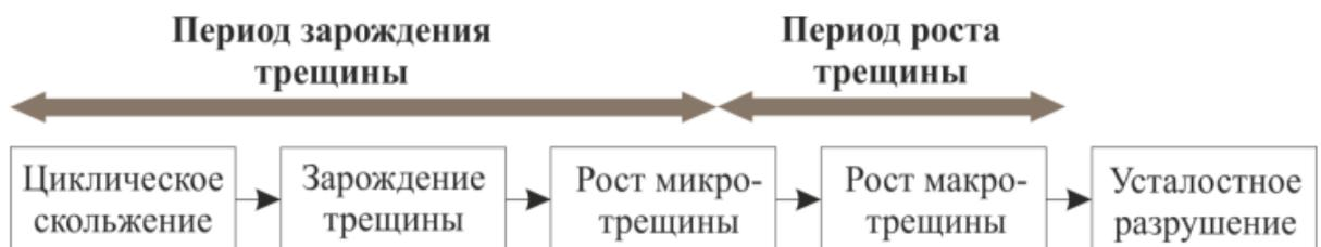
Рисунок. 1.4 – Периоды зарождения и роста трещин [53]
