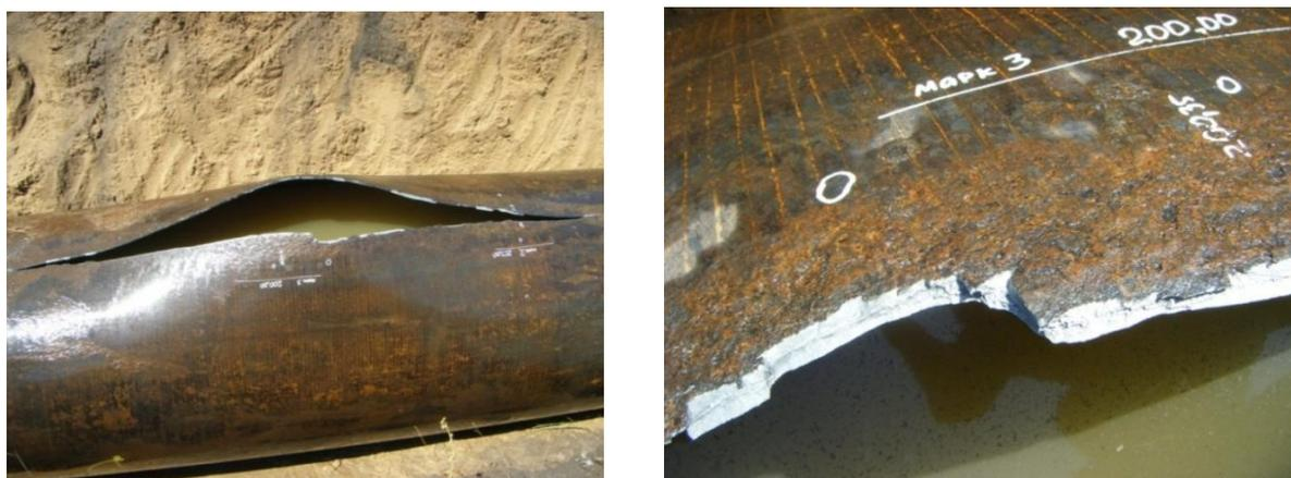
Рисунок 1.11 – Зона разрушения трубы, где а – общий вид разрушившейся трубы; б – очаг разрушения [76]
