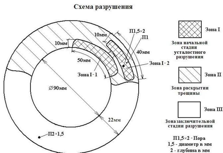
Рисунок 1.15 – Схема разрушения задвижки [114]
