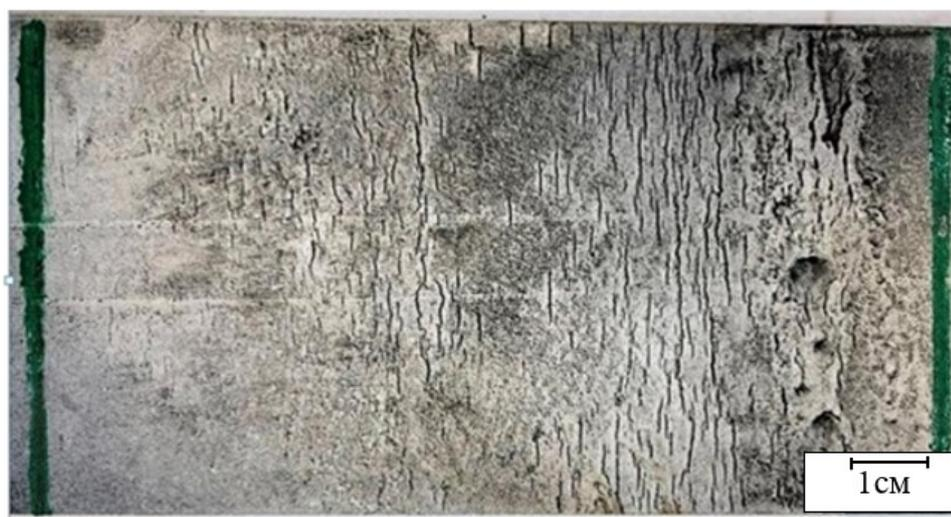
Рисунок 3.10 – Фотография зоны КРН фрагмента №4(9П) после проведения магнитопорошкового контроля [86]
