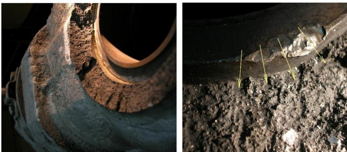
Рисунок 1.14 – Излом задвижки фонтанной арматуры [114]
