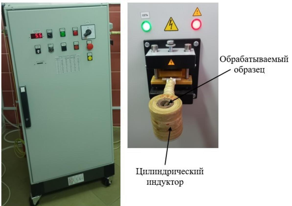
Рисунок 3.13 – Магнитно-импульсная установка МИУ- 5кДж [86]
