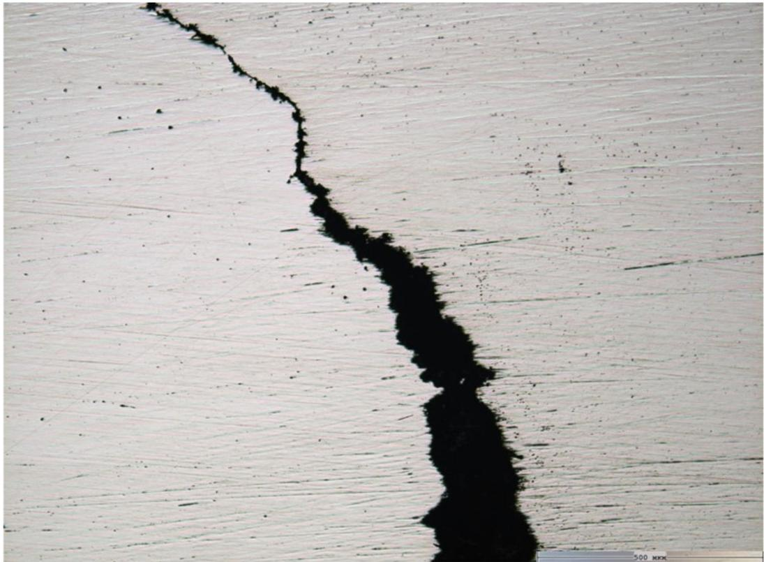
Рисунок 4.9 – Исходное состояние зоны (б) микротрещины при 100-кратном увеличении [118]
