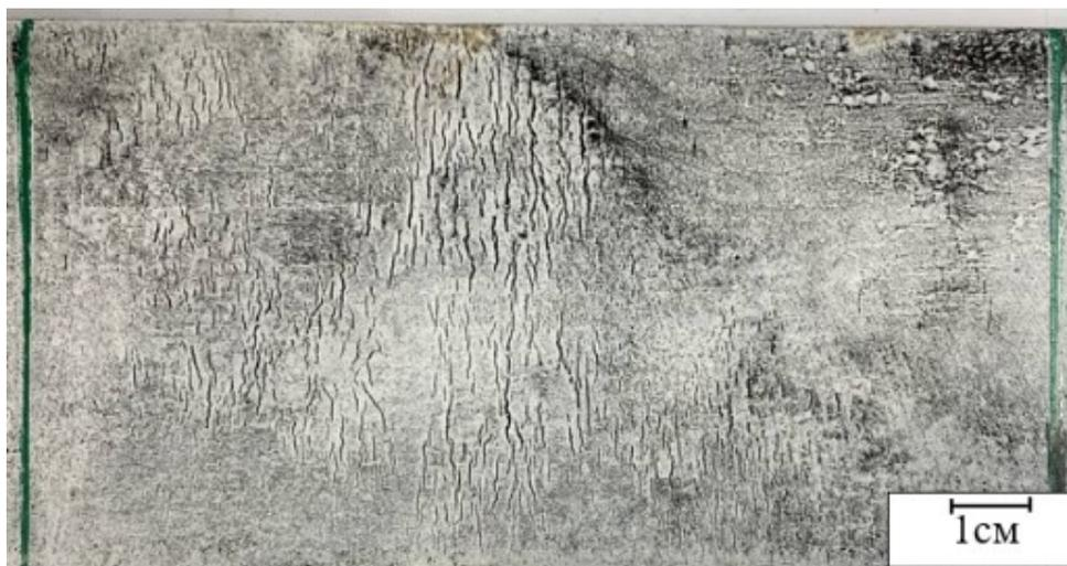
Рисунок 3.6 – Фотография зоны КРН фрагмента №2(5П) после проведения магнитопорошкового контроля [86]
