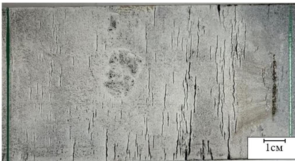
Рисунок 3.2 – Фотография зоны КРН фрагмента №1(2П) после проведения магнитопорошкового контроля [86]
