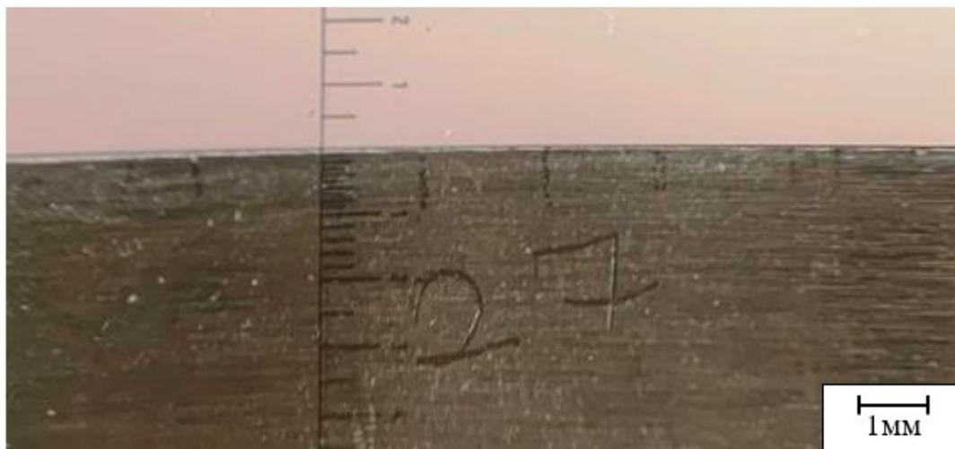
Рисунок 3.12 – Изображение боковой поверхности образца, вырезанного из зоны коррозионного растрескивания под напряжением фрагмента №4(9П), полученное с помощью лупы при десятикратном увеличении [86]
