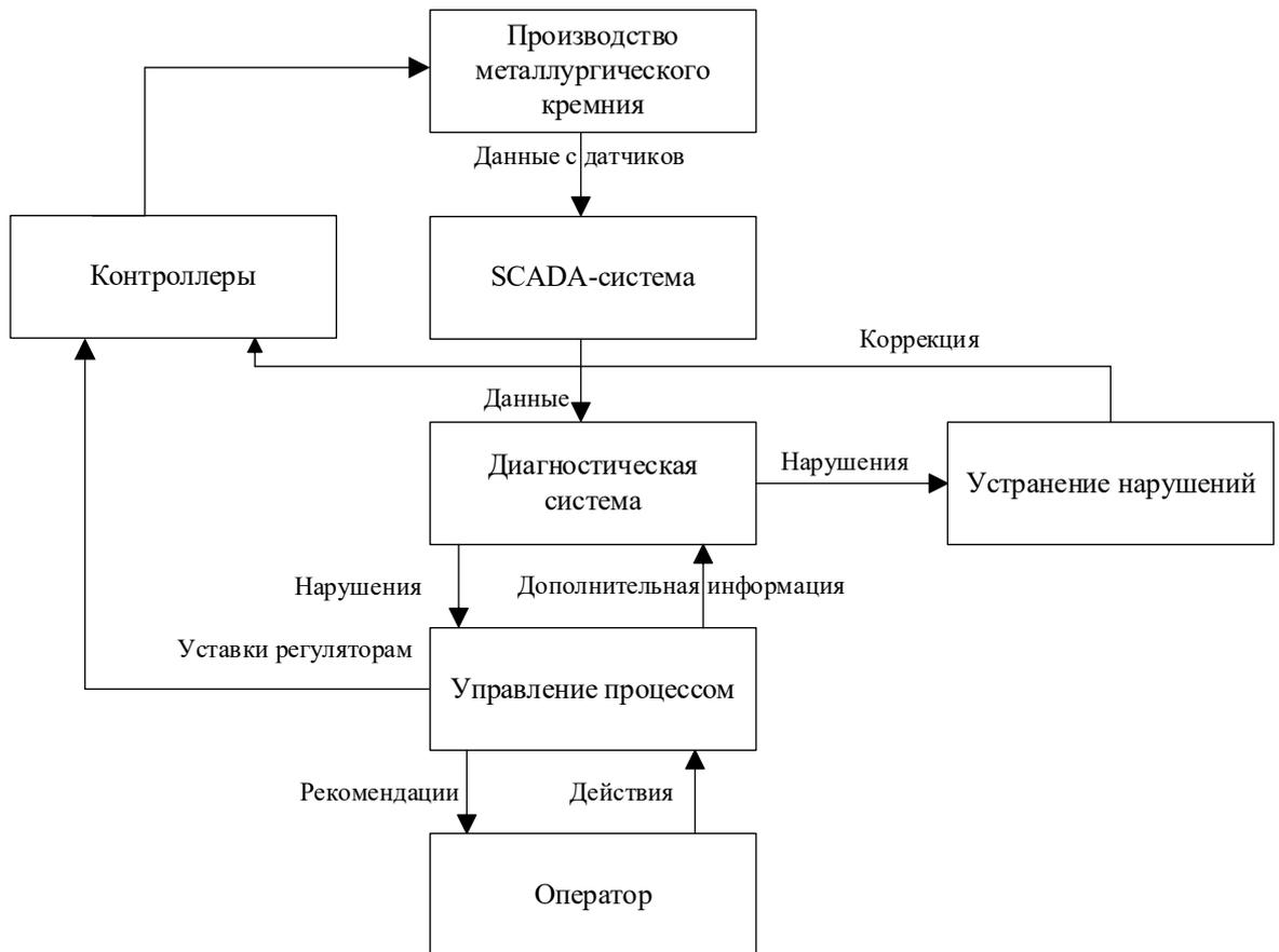
Рисунок 1.9 – Место диагностической системы в АСУ ТП выплавки металлургического кремния
