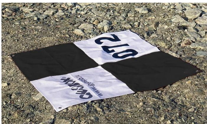
Рисунок 1.1 - Опознак при фотограмметрической съёмке с квадрокоптером
