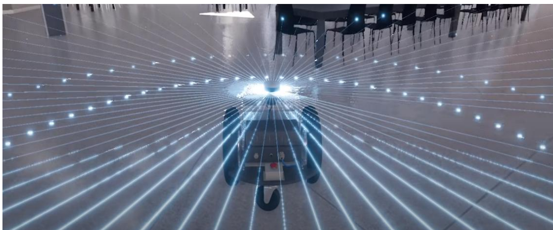
Рисунок 1.6 – Платформа NVIDIA Isaac с установленным лазерным сканером, технологическая конференция Nvidia, 2018
