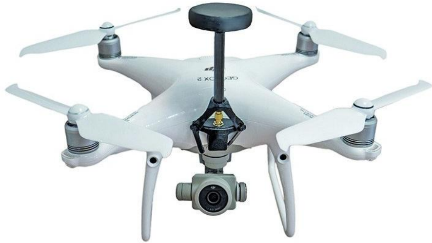
Рисунок 1.2 - Геодезический квадрокоптер DJI 4 PRO с установленным GPS-приёмником
