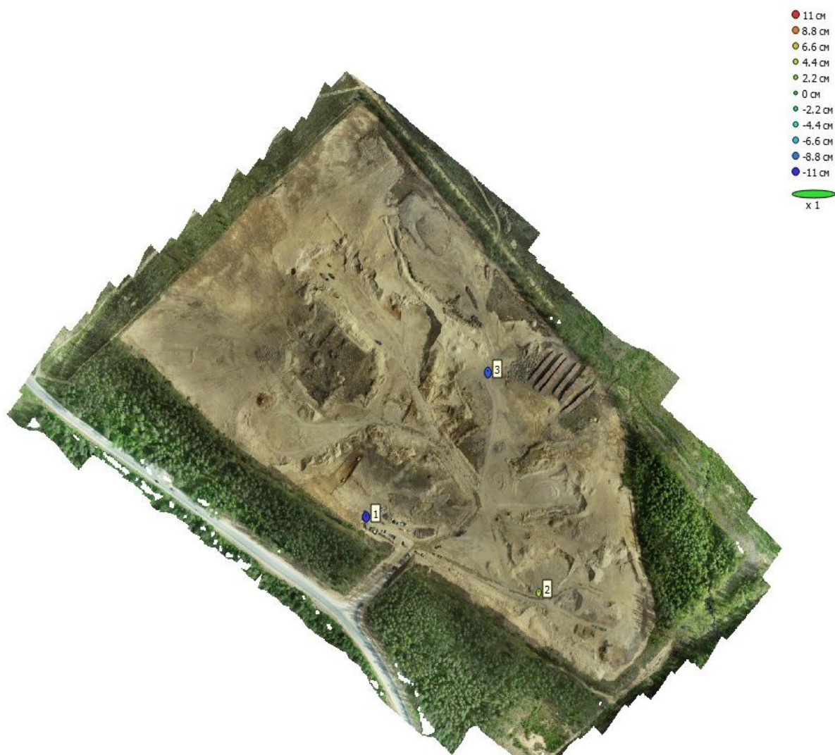
Рисунок 3.1 – Точность полученного облака точек относительно опорных пунктов
