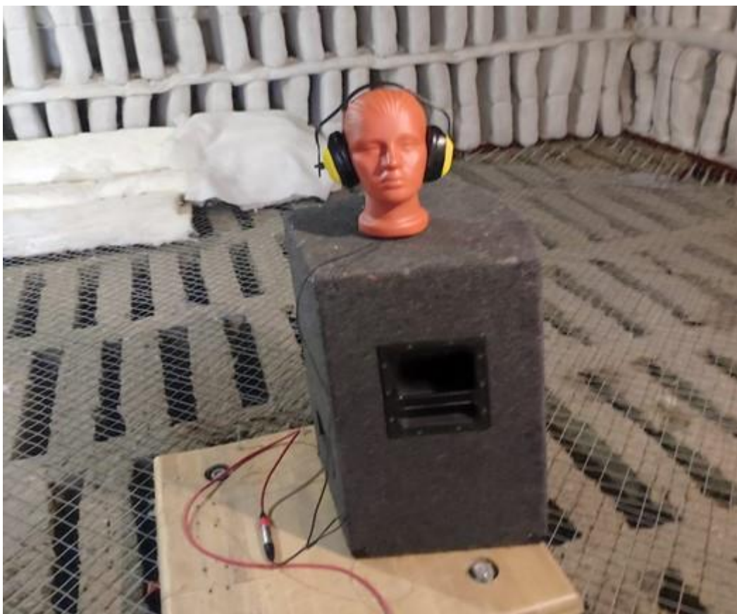
Рисунок 4.8 – Экспериментальный стенд измерения акустической эффективности с использованием искусственной головы
