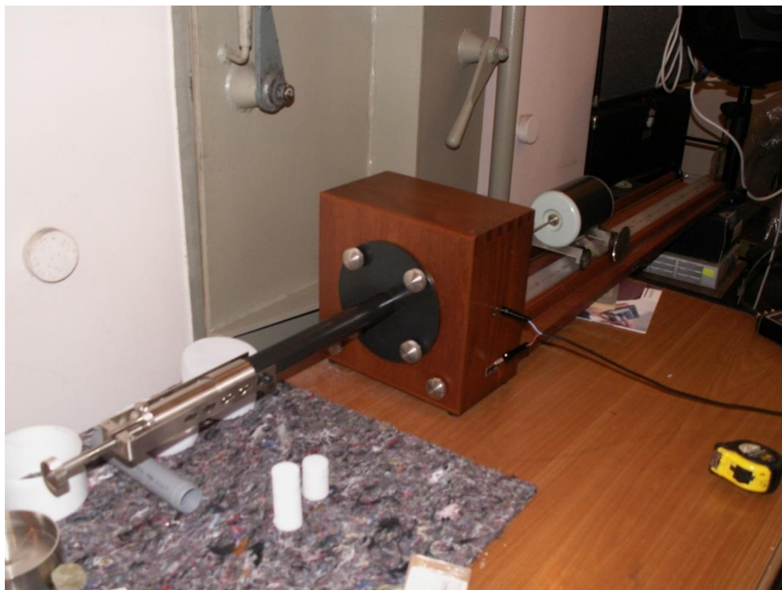
Рисунок 4.3 – «Короткая» трубка Кундта в экспериментальном стенде
