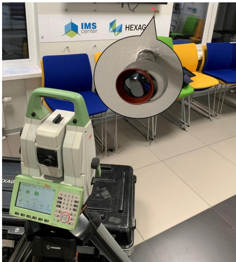
Рисунок 4.13 – Создание системы координат путем позиционирования лазерного сканера по сферическим отражателям
