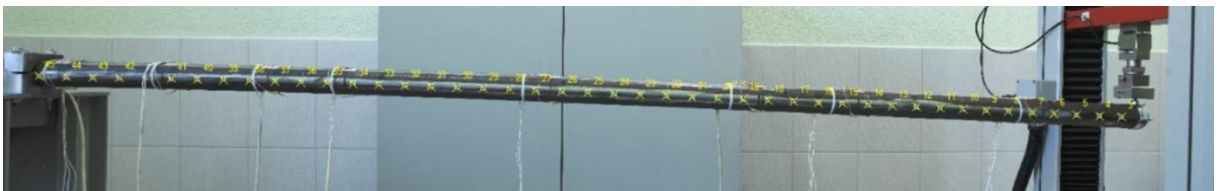
Рисунок 4.10 – Фотография трубы с отмеченными на ней центрами маркеров [142]
