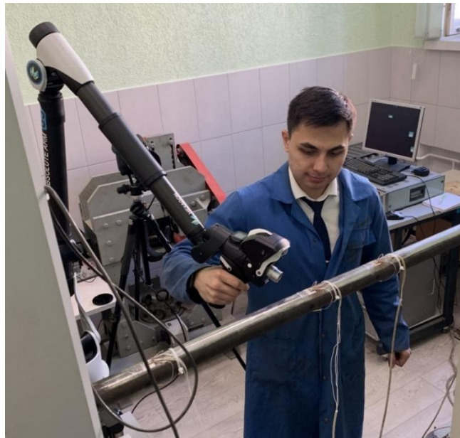
Рисунок 4.6 – Процесс лазерного сканирования исследуемого трубопровода [142]
