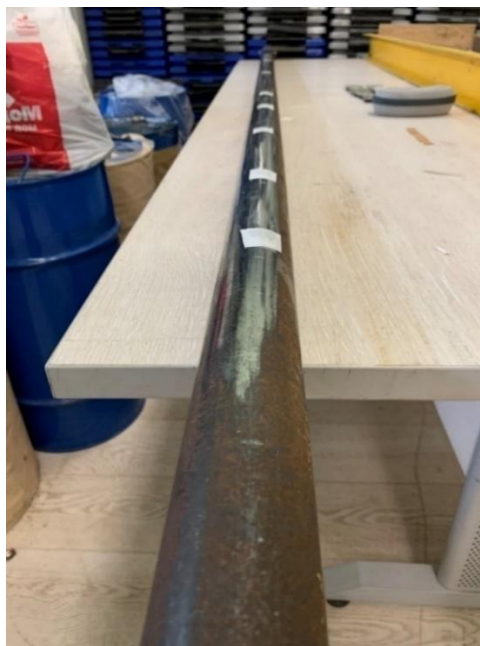
Рисунок 4.2 – Исследуемая труба длиной 2,4 м, наружным диаметром 51 мм и толщиной стенки 3 мм [142]
