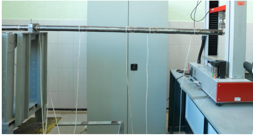
Рисунок 4.5 – Исследуемая труба в изогнутом состоянии [142]
