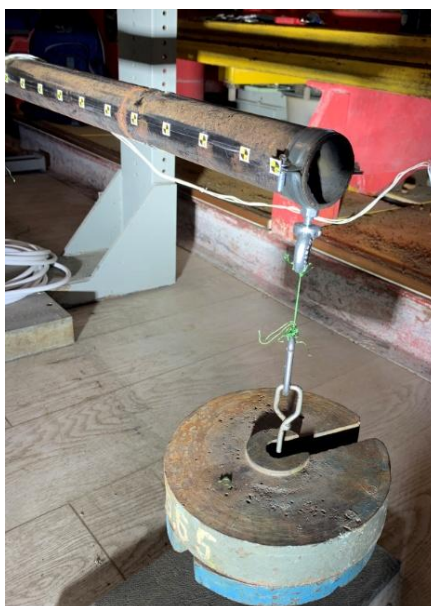
Рисунок 3.9 – Груз, подвешенный на свободном конце трубы
