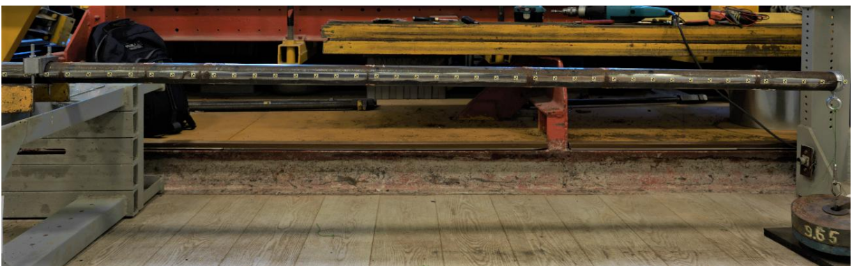
Рисунок 3.16 – Труба в результате ее изгиба при расстоянии 2 м от сечения жесткой заделки до свободного конца
