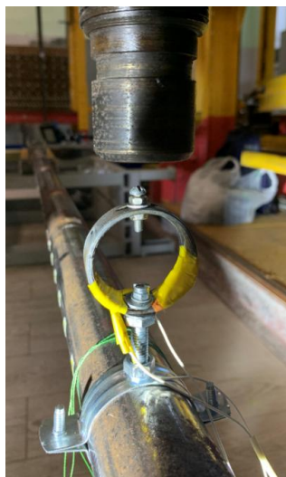
Рисунок 3.13 – Внешний вид тензометрического кольца, установленного на трубу
