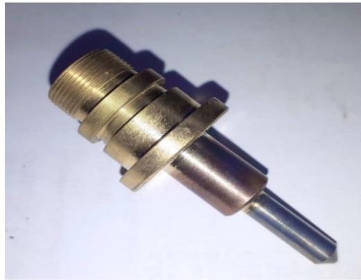
Рисунок 1.5 - Вольфрамовый катод с водоохлаждаемой обоймой плазмотрона ПМК-5
