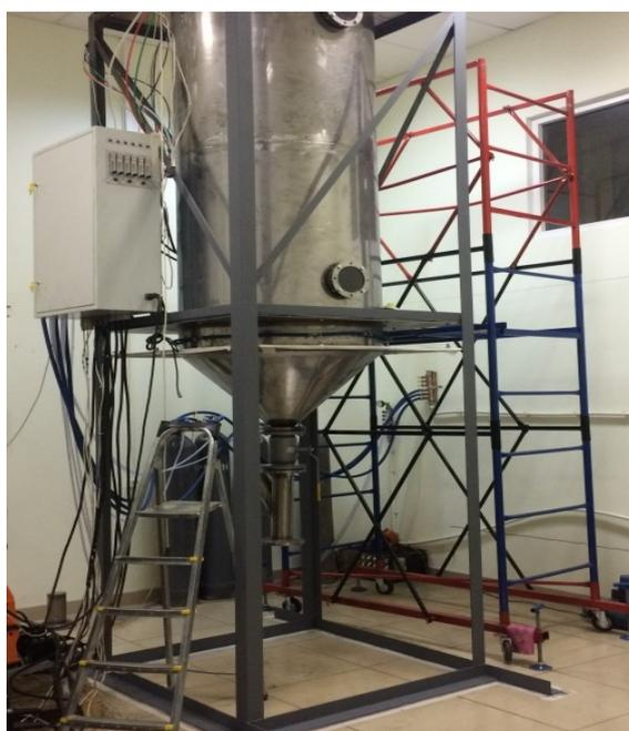
Рисунок 3.6 - Камера распыления параметрического комплекса
