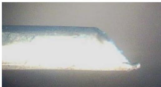
Рисунок 1.10 – Внешний вид оплавленного торца проволоки после распыления поперечной струей плазмы [58]
