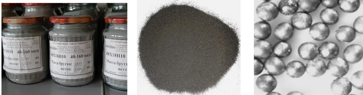
Рисунок 5.8 - Порошок нержавеющей стали, полученный на АО «ОЗ «Микрон»
