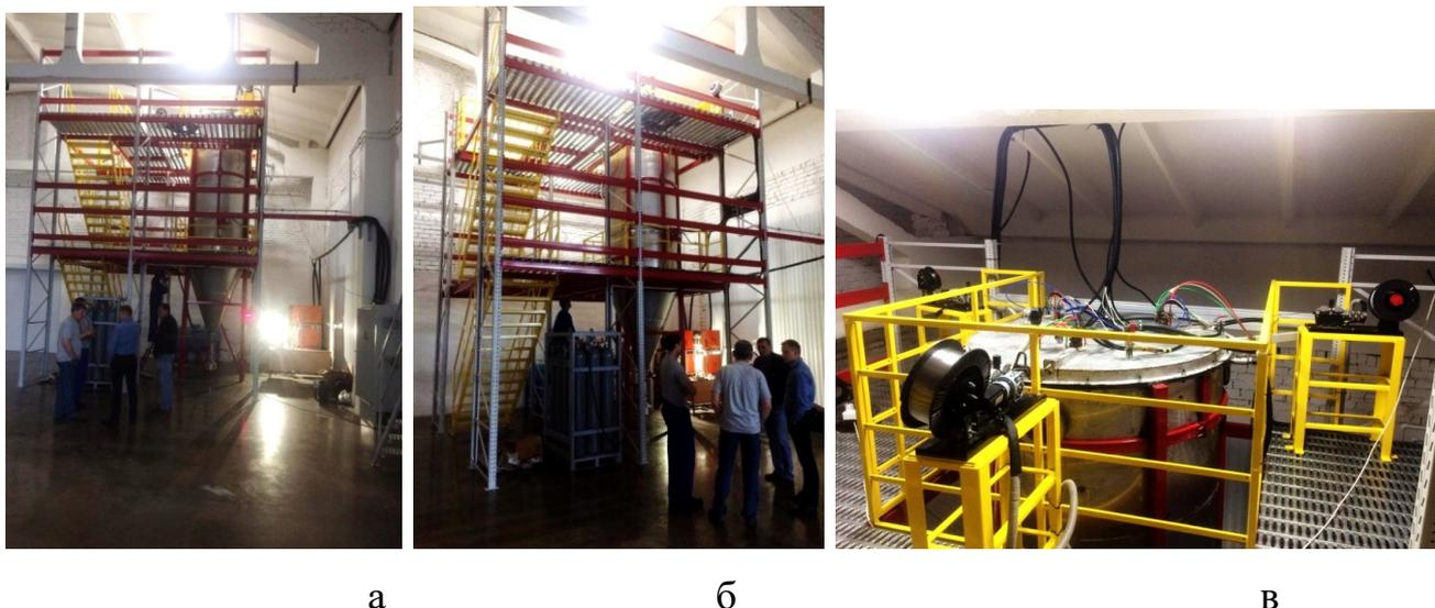
Рисунок 5.8 - Общий вид атомайзера (а, б) и компоновка плазмотронов и подающих устройств на верхней крышке колонны распыления (в)
