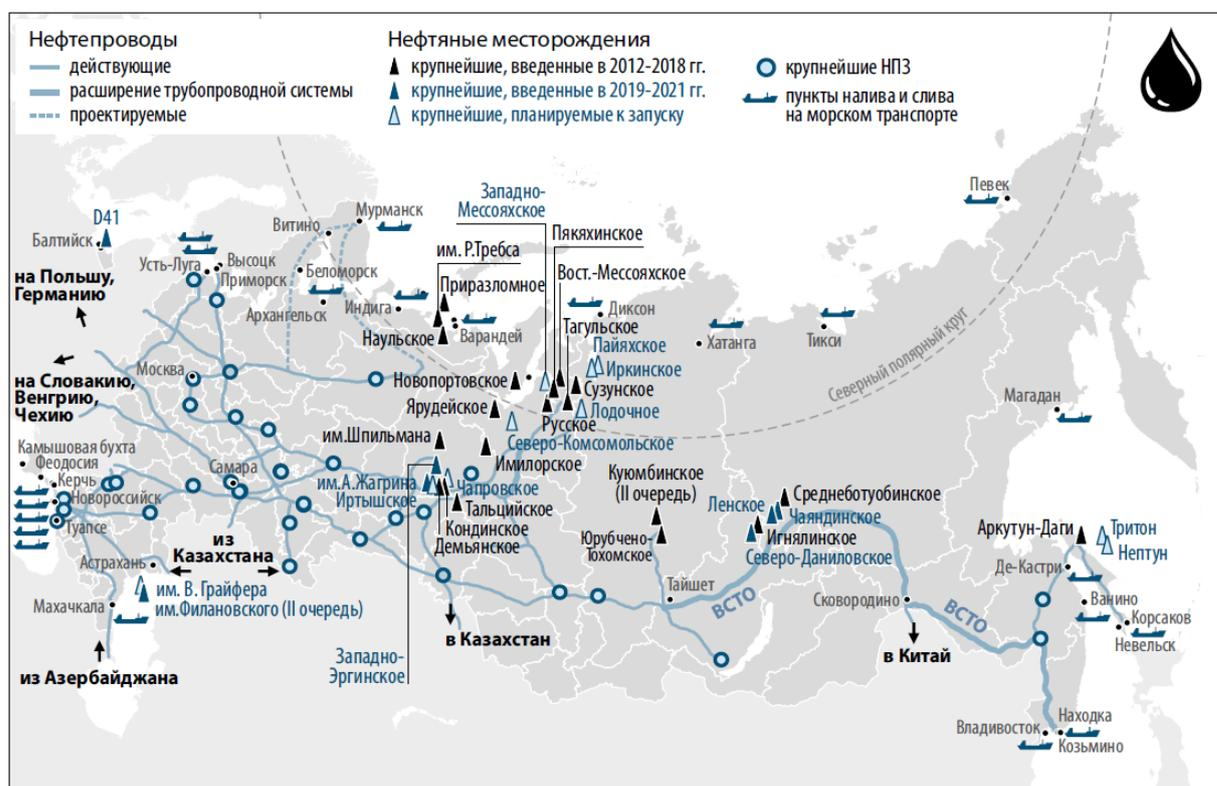
Рисунок 1.3 – Укрупненная схема нефтяной промышленности и системы магистральных трубопроводов [30]
