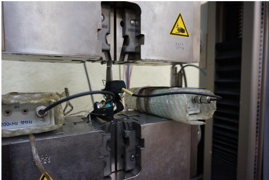
Рисунок 3.7 – Вид образца сварного соединения с установленными предусилителями и ПАЭ
