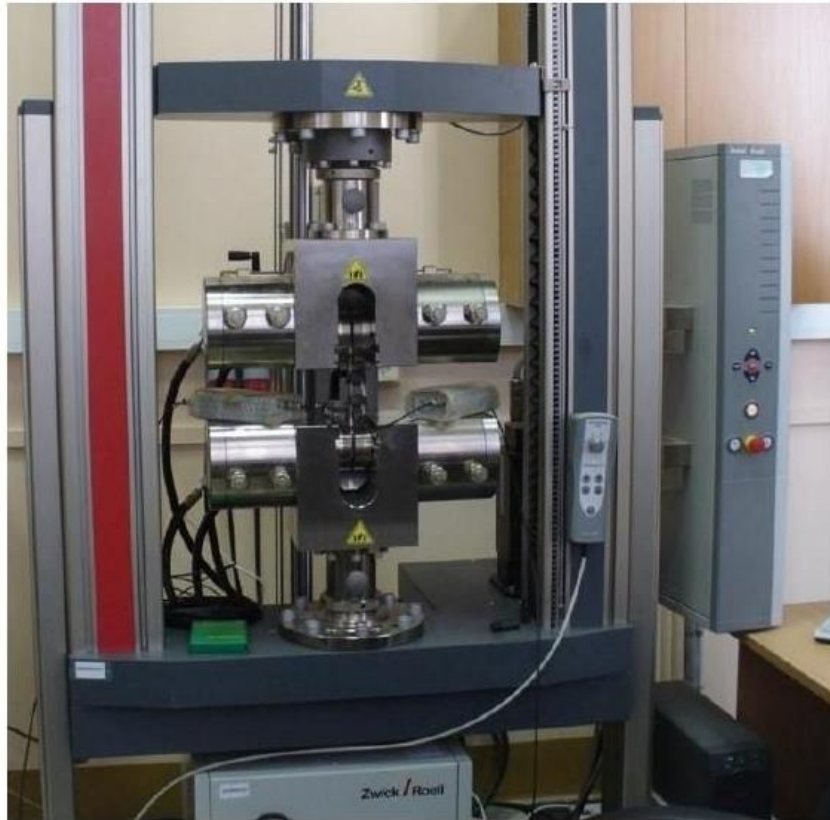
Рисунок 3.2 – Универсальная разрывная машина Zwick/Roell Z100, использовавшаяся для нагружения образцов
