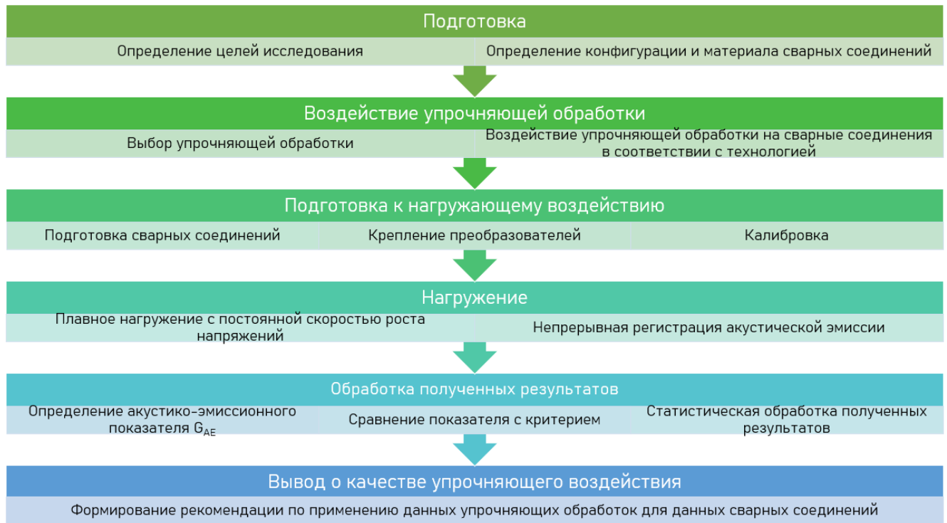
Рисунок 4.2 – Структурная схема методики по оценке влияния упрочняющих обработок на сварные соединения
