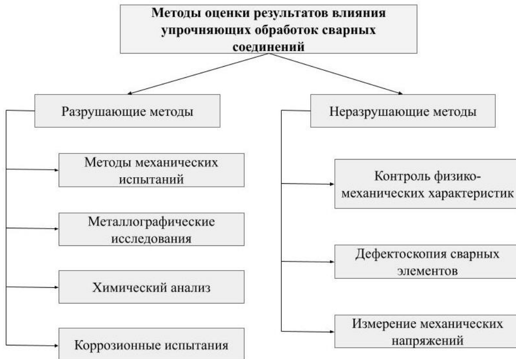
Рисунок 1.7 – Классификация методов контроля влияния упрочняющих обработок сварных соединений
