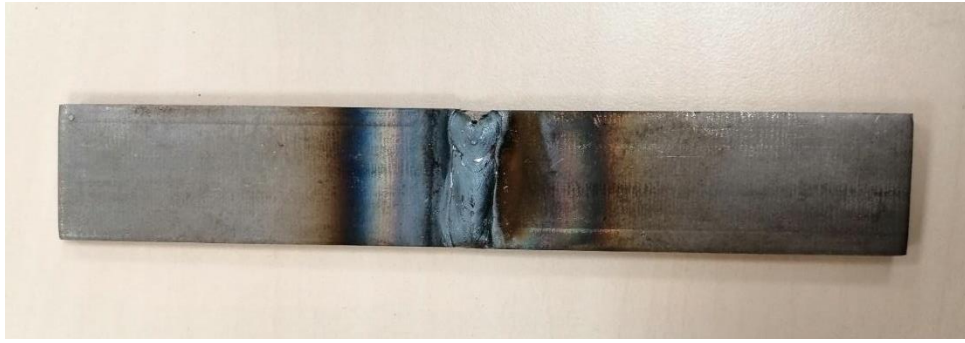
Рисунок 3.1 – Типовой образец, изготовленный из Ст3пс для проведения исследований
