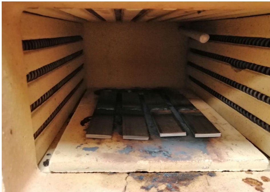
Рисунок 3.4 – Процесс термообработки сварных соединений для проведения экспериментальных исследований
