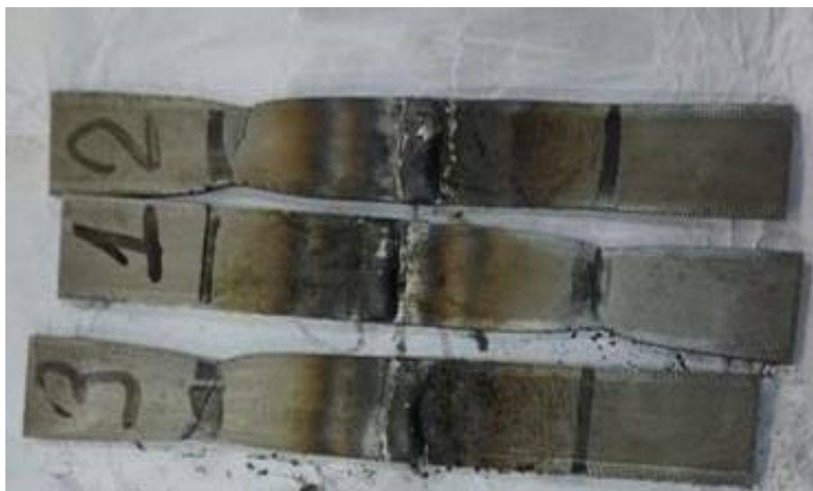
Рисунок 3.13 – Вид образцов после проведения статического растяжения
