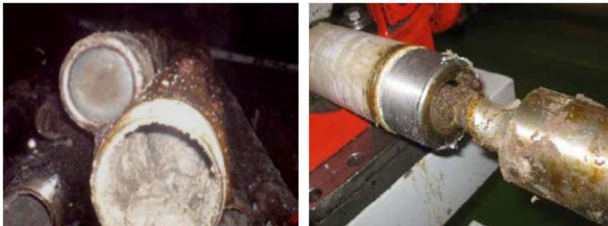
Рисунок 1.5 – Образование песчаной пробки в насосно-компрессорной трубе (слева) и забившийся электровинтовой насос (справа) [45]
