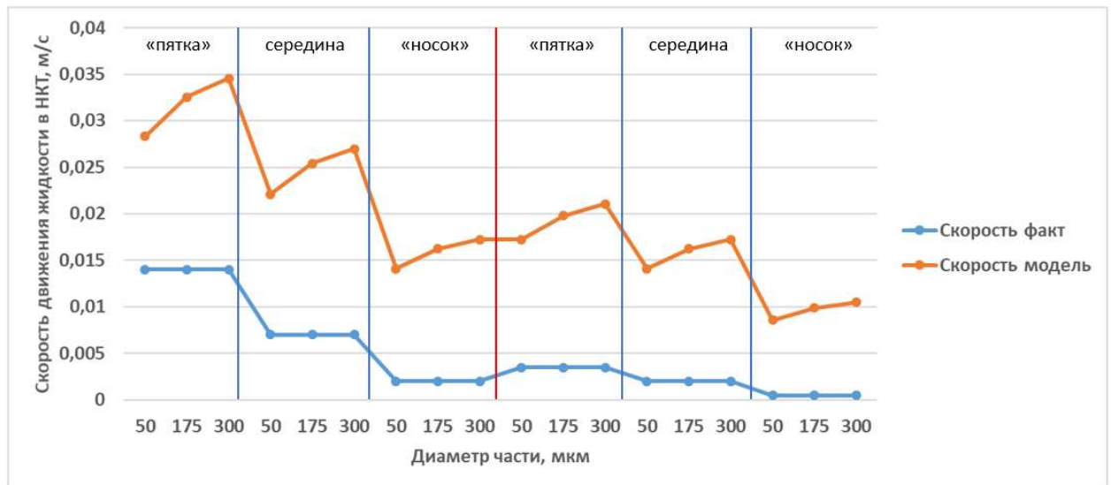
Рисунок 2.27 – Расчет по модели Салама (Salama). Левая часть (до красной черты) – работа скважины при депрессии 1,3 МПа, правая часть – работа скважины при депрессии 0,33 МПа
