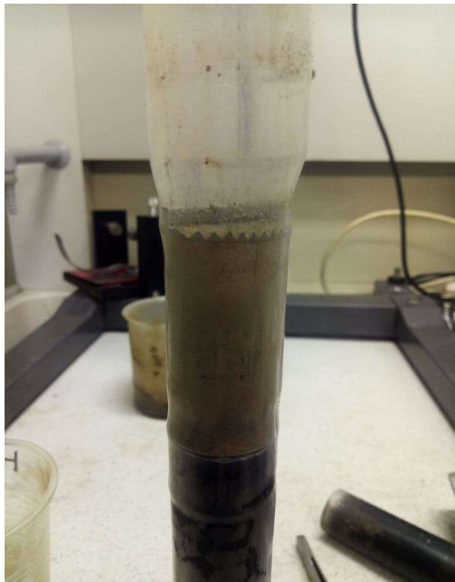
Рисунок 3.2 – Насыпная модель с купоном проволочного фильтра
