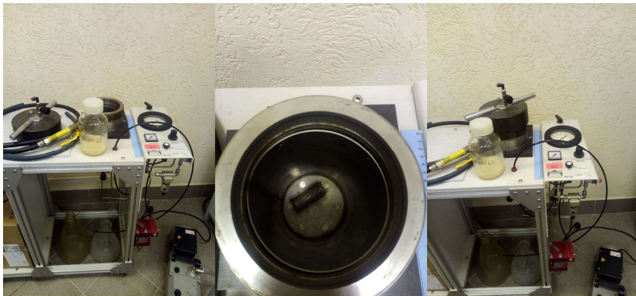
Рисунок 3.16 – Сатуратор, модель в ячейке сатуратора, насыщение модели
