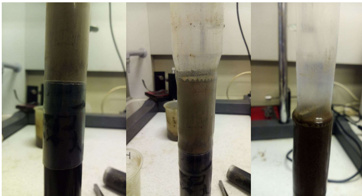
Рисунок 3.14 – Уплотненная насыпная модель, установка купона, обжатие купона трубкой
