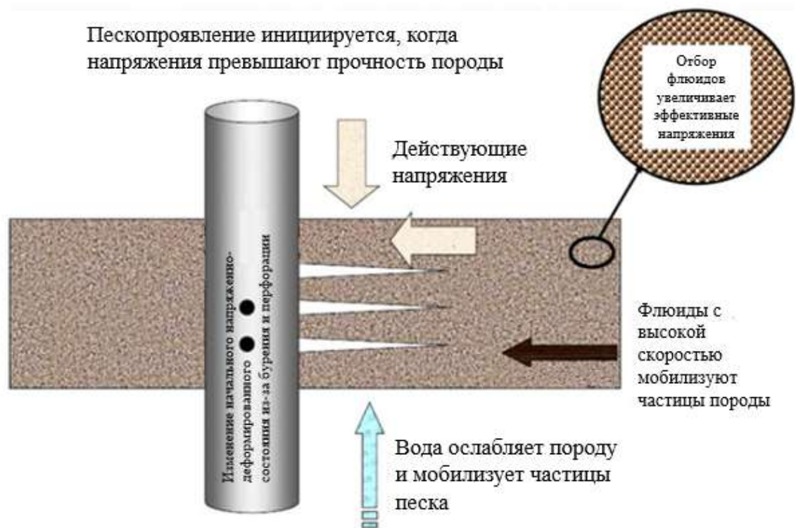
Рисунок 1.2 – Разрушение породы под воздействием действующих сил [57]
