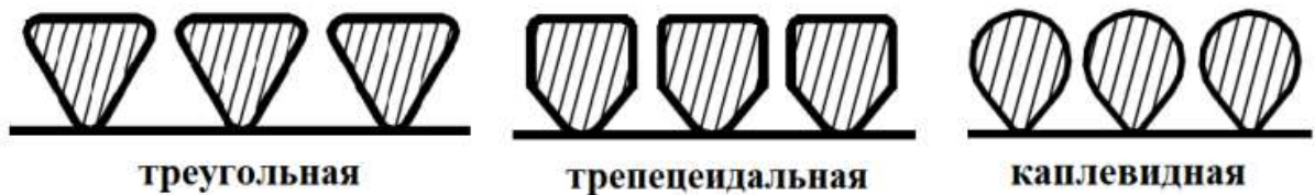
Рисунок 3.72 – Формы намотки проволоочных фильтров на Этапе 3
