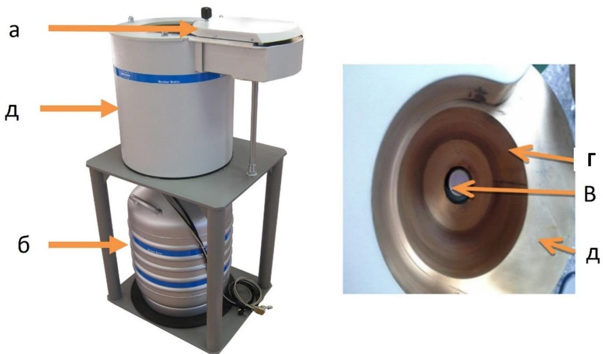
Рисунок 3.12 – Установка измерения защитных свойств материалов Система защиты включает в себя следующие компоненты: (а) дверца, плотно прилегающая к корпусу экрана, (б) криостат с жидким азотом, (в) детектор, расположенный в центре экрана, (г) цилиндр свинцовый толщиной 10 см и (д) внутренний слой из меди толщиной 0,1 см.
