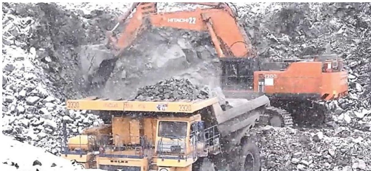
Рисунок 1.3 – Выемочно-погрузочные работы
