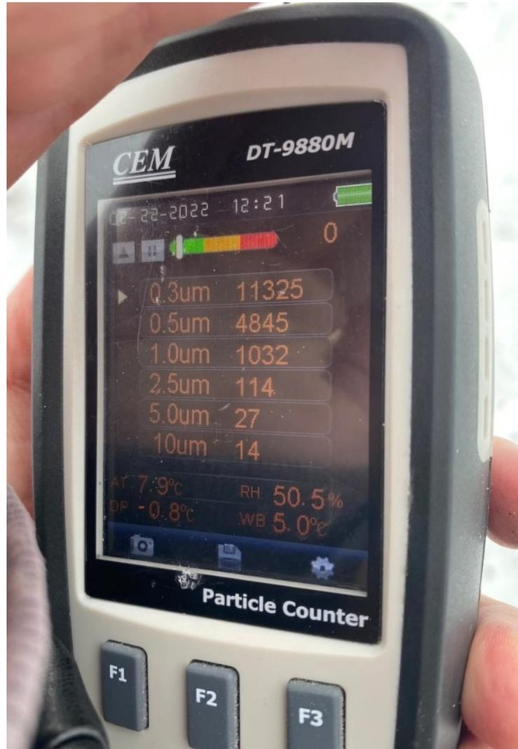
Рисунок 3.1 – счетчик пылевых частиц «CEM DT-9880»
