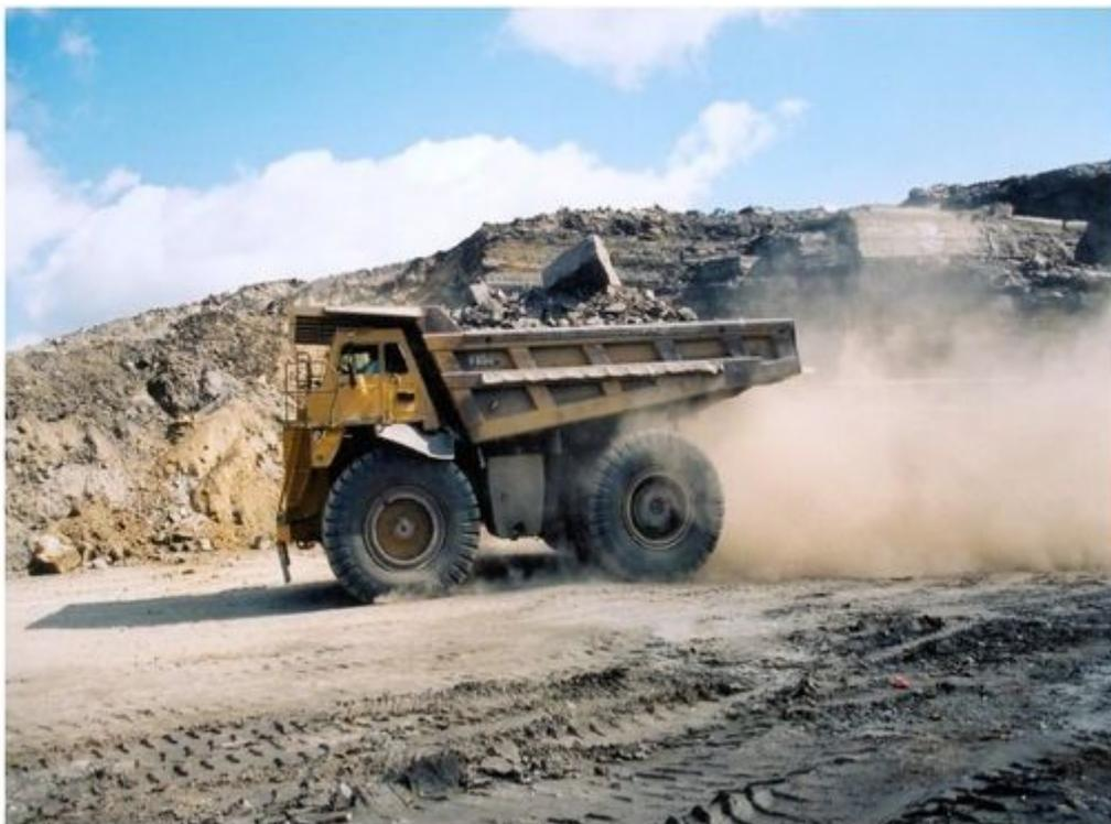
Рисунок 1.5 – Транспортирование горной массы
