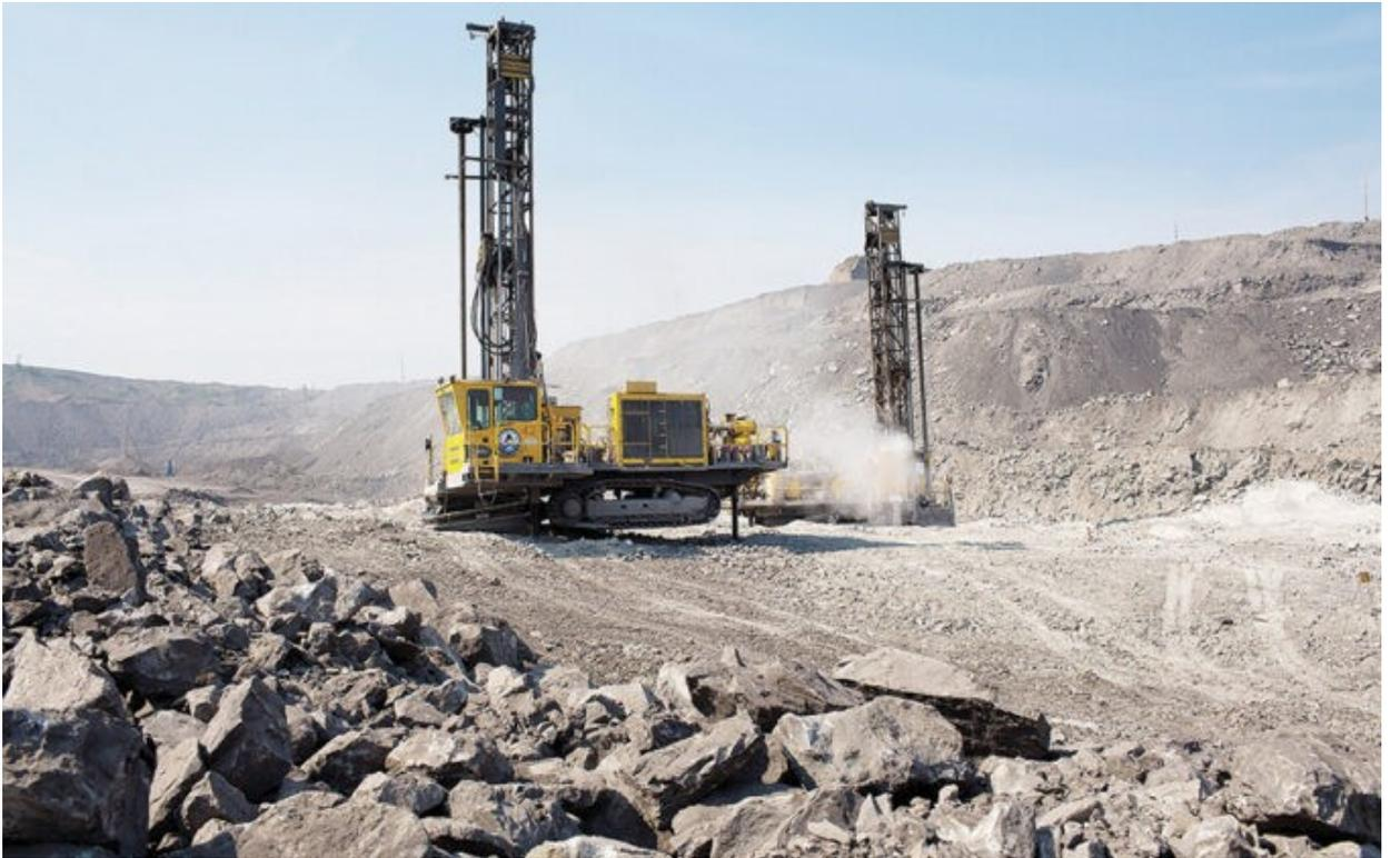
Рисунок 1.1 – Бурение взрывных скважин
