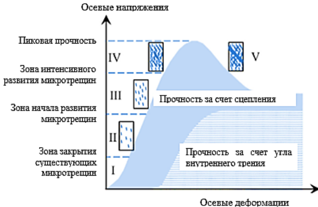
Рисунок 2.11 – Развитие сцепления и угла внутреннего трения по мере нагружения образца горной породы и формирования трещин [16]
