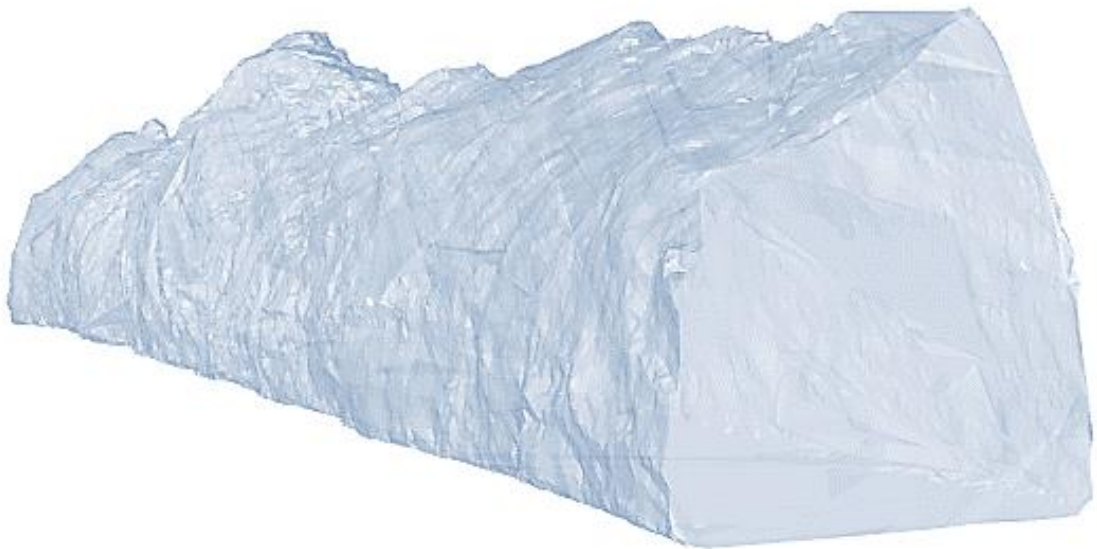
Рисунок 2.3 – Пример замера зоны хрупкого разрушения маркшейдерской службой
