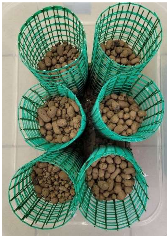
Рисунок 3.2 – Цилиндрические ячейки с загрузкой для укоренения растительности
