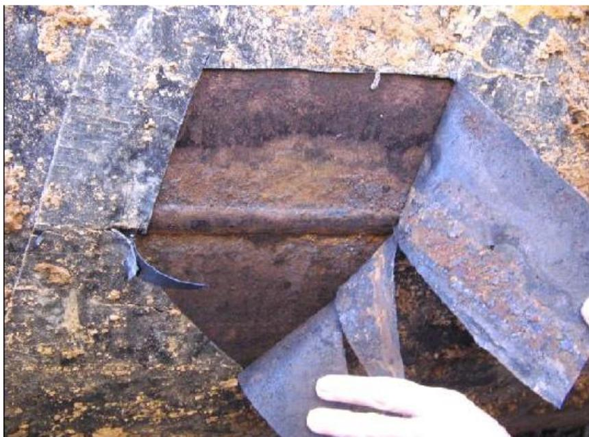
Рисунок 1.6 – Вид трубы магистрального трубопровода на участке с отслоившейся изоляцией [43]
