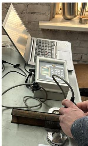
Рисунок 4.6 – Процесс исследования образца с применением сканера механических напряжений «Stressvision»
