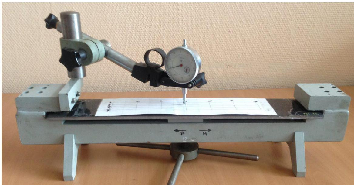
Рисунок 2.13 – Вид устройства для трехточечного изгиба образцов в снаряженном состоянии
