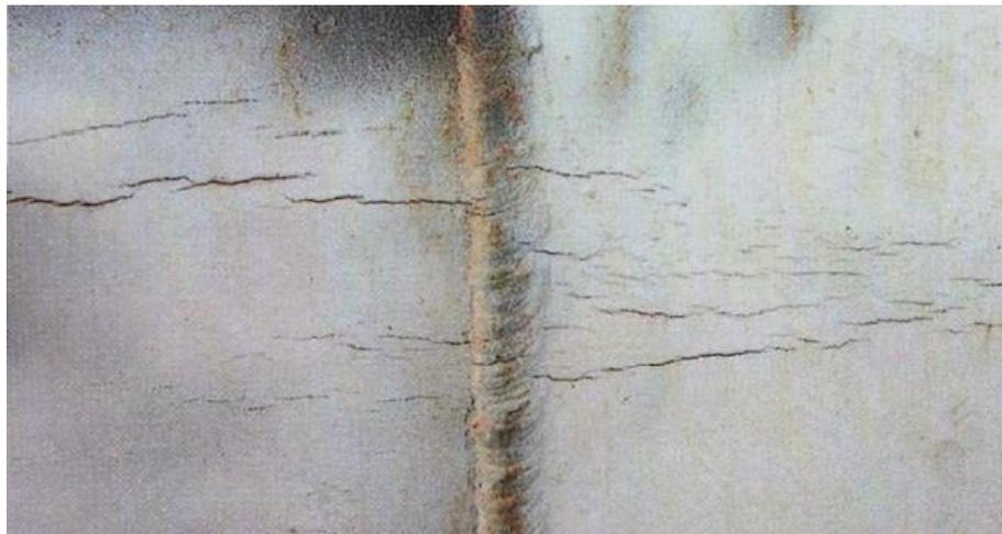
Рисунок 1.3 – Продольные трещины в результате стресс-коррозии в области сварного соединения трубопровода [43]
