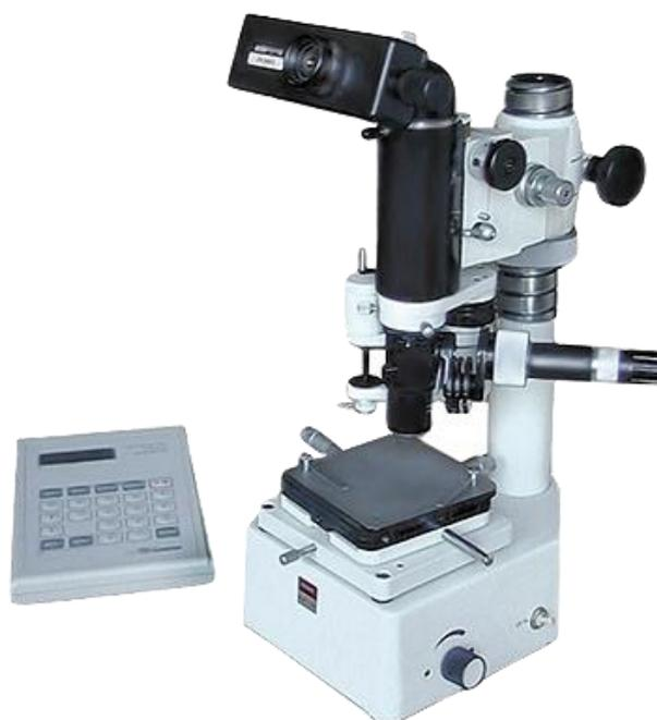
Рисунок 2.11 – Вид прибора ПМТ-3, использованного для измерения поверхностной микротвердости наводороженной зоны пластин
