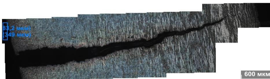
Рисунок 4.4 – Вид трещины поперечном сечении стенки фрагмента
