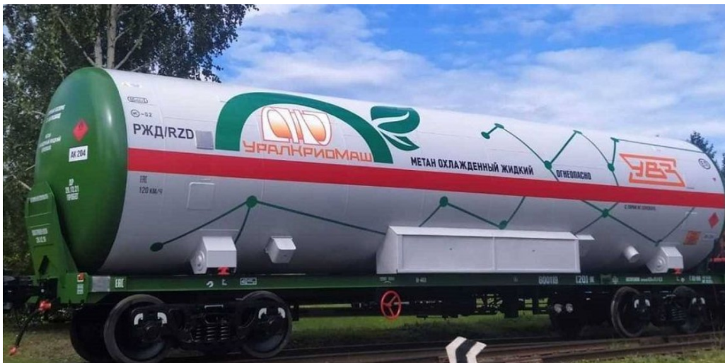
Рисунок 1.13 – Внешний вид вагон-цистерны для транспортировки СПГ [19]
