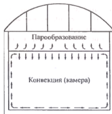
Рисунок 1.10 – Пример парообразования при хранении однородного СПГ в резервуаре [4]
