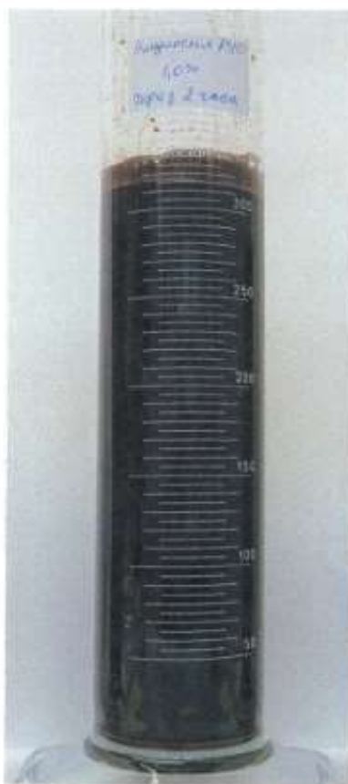
Рисунок 2.1 – Эмульсия + 1,0% коагулянта после 2 часов отстоя
