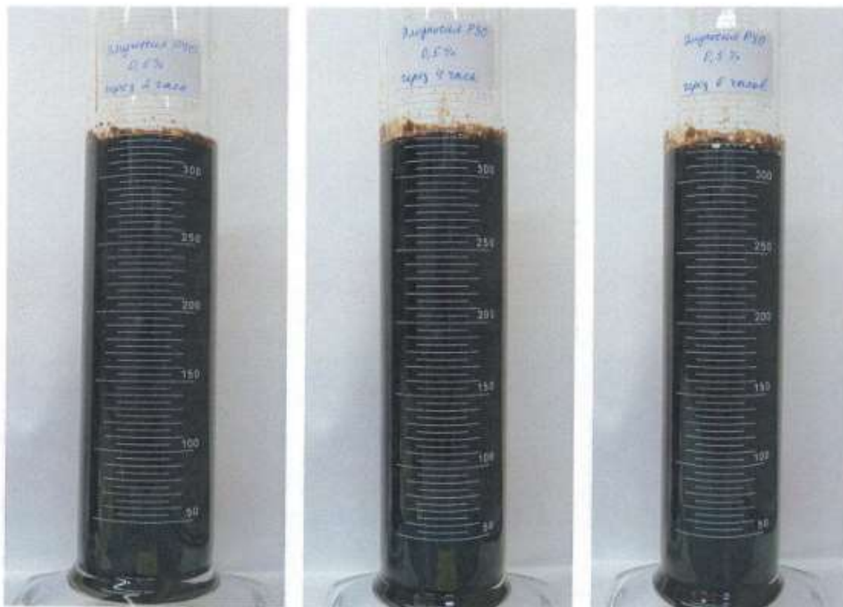
Рисунок 1.4 – Эмульсия + 0,5% коагулянта после 2 часов отстоя
