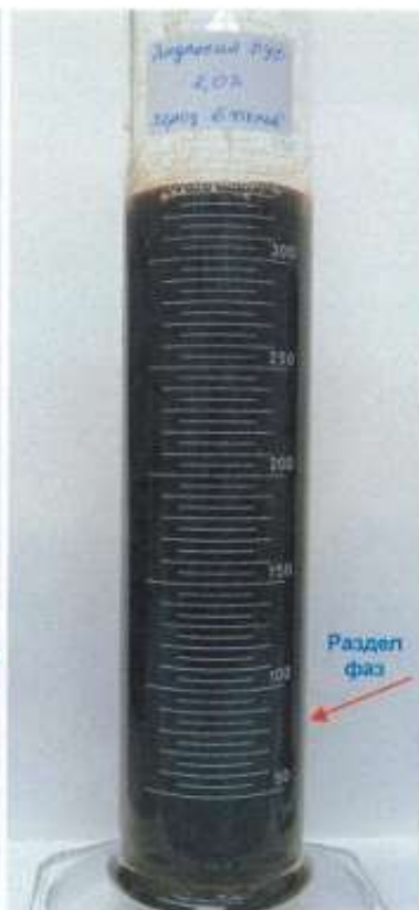
Рисунок 3.3 – Эмульсия + 2,0% коагулянта после 6 часов отстоя
