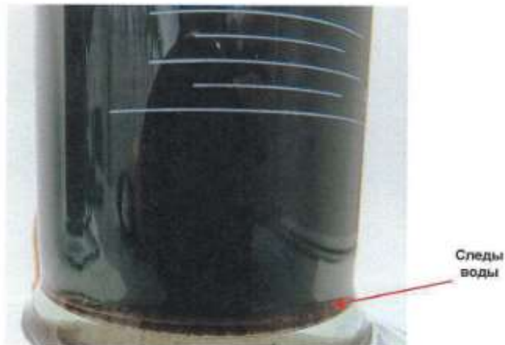
Рисунок 8.4 – Нижняя часть цилиндра после 6 часов отстоя со следами воды
