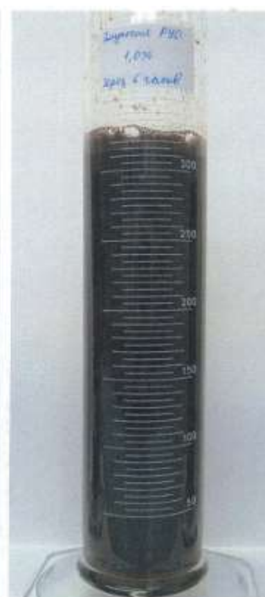
Рисунок 2.3 – Эмульсия + 1,0% коагулянта после 6 часов отстоя
