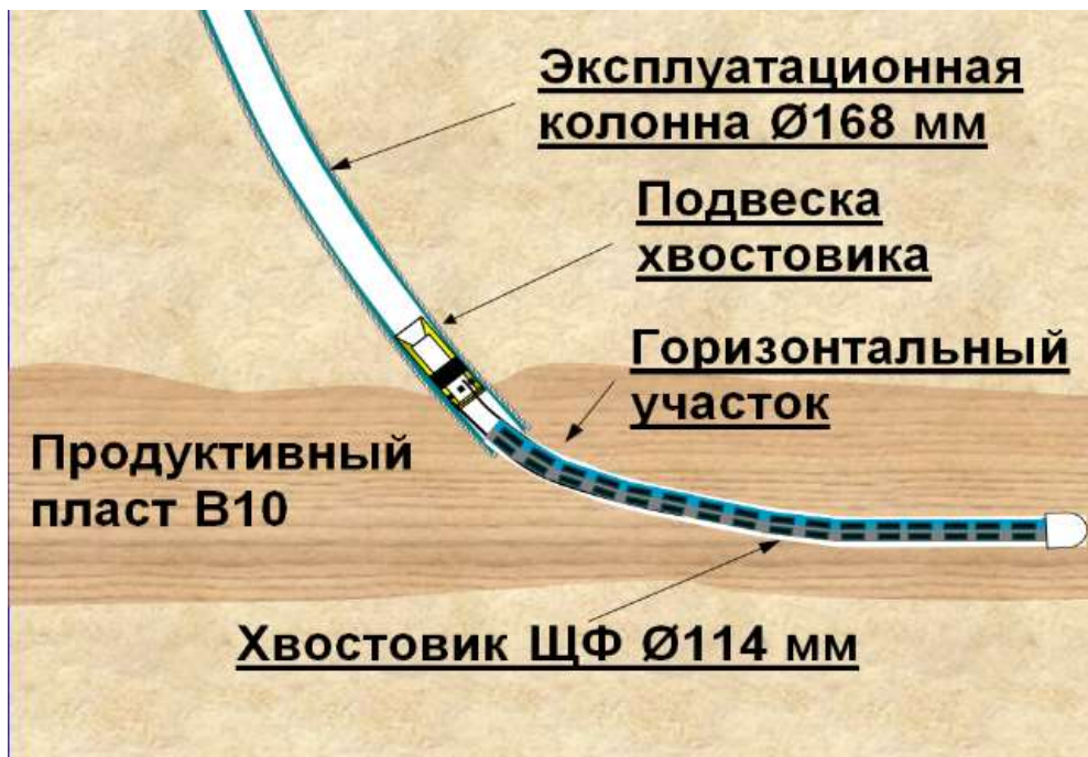
Рисунок 3.8 – Предлагаемая схема окончания эксплуатационной добуриваемой скважины.
