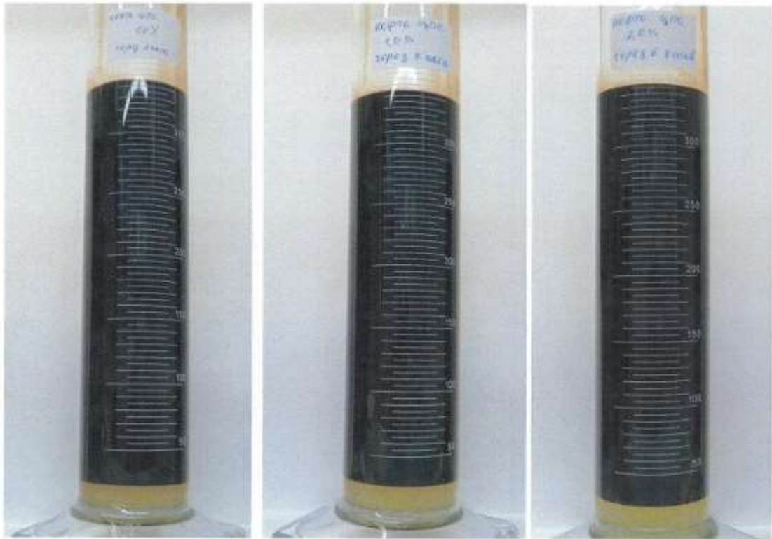
Рисунок 6.1 – Нефть сырая + 1,0% коагулянта после 2 часов отстоя
