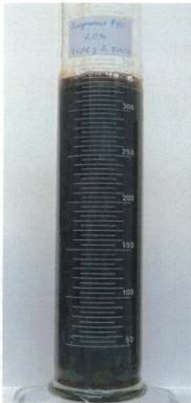
Рисунок 3.1 – Эмульсия + 2,0% коагулянта после 2 часов отстоя
