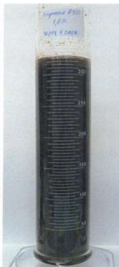
Рисунок 2.2 – Эмульсия + 1,0% коагулянта после 4 часов отстоя
