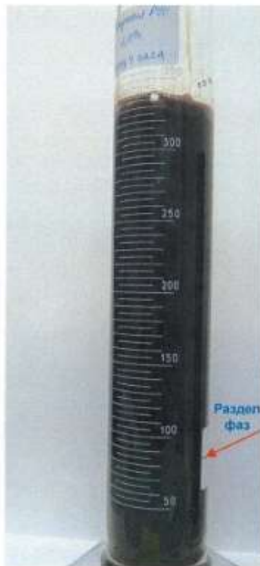
Рисунок 3.2 – Эмульсия + 2,0% коагулянта после 4 часов отстоя
