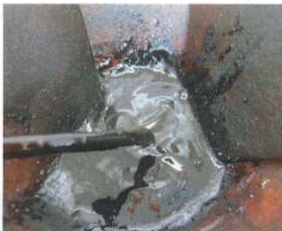
Рисунок 1.1 – Внешний вид эмульсии после добавления 0,5% коагулянта после 6 часов отстоя
