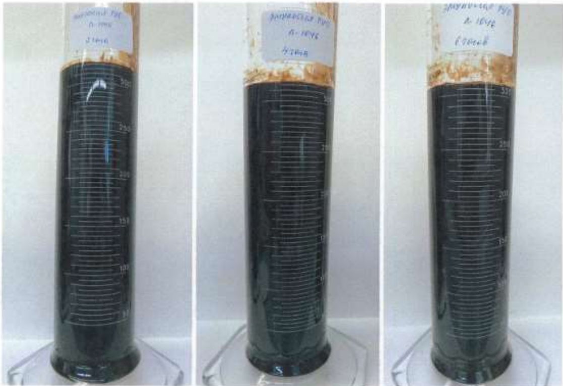
Рисунок 4.1 – Эмульсия + Л-1046 с дозировкой 40 г/т после 2 часов отстоя
