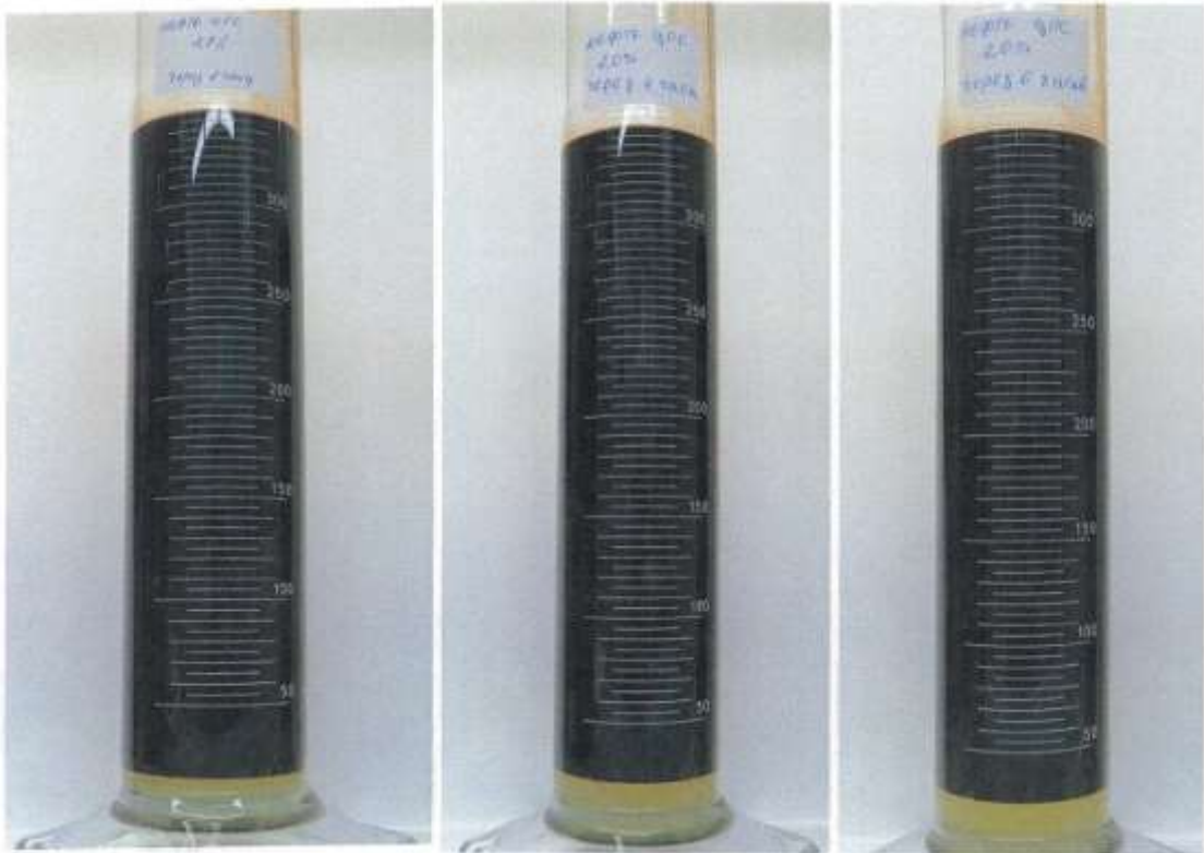
Рисунок 7.1 – Нефть сырая + 2,0% коагулянта после 2 часов отстоя
