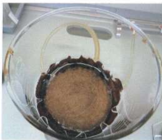
Рисунок 1.3 – Воронка с бумажным фильтром после разделения фаз эмульсии
