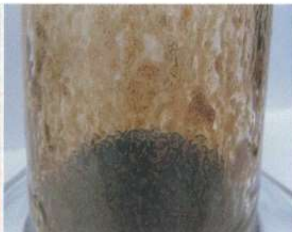
Рисунок 1.2 – Остатки эмульсии на внутренней поверхности цилиндра после 6 часов отстоя
