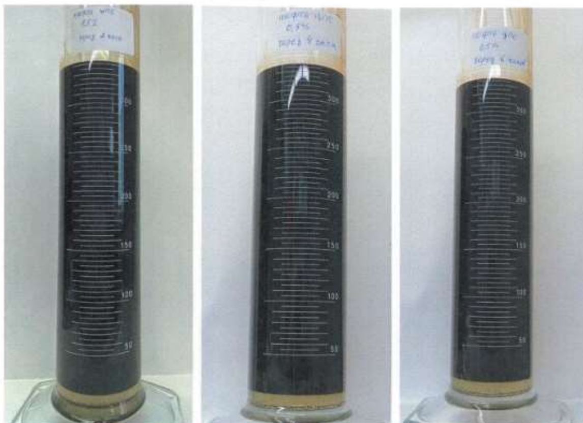
Рисунок 5.1 – Нефть сырая + 0,5% коагулянта после 2 часов отстоя
