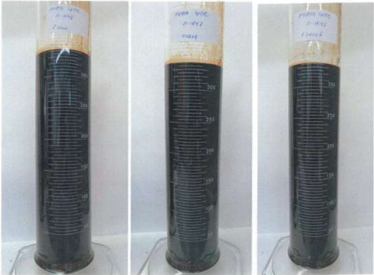
Рисунок 8.1 – Нефть сырая + Л-1046 с дозировкой 40 г/т после 2 часов отстоя
