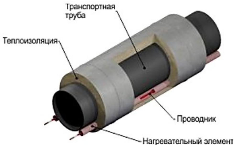
Рисунок 1.7 - Схема электрообогрева трубопровода
