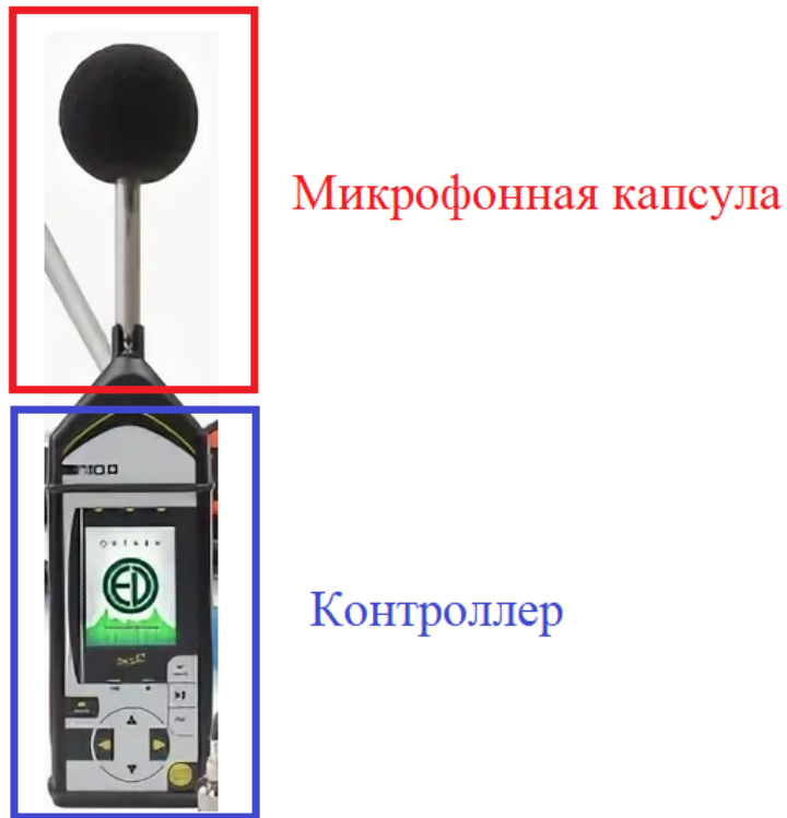
Рисунок 2.1 – Устройство шумомера «ЭКОФИЗИКА-110А»
