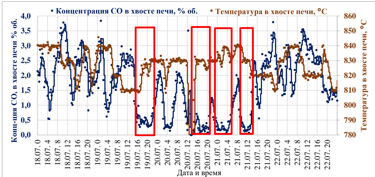
Рисунок 4.26 – Концентрация СО в отходящих газах и температура в хвосте трубчатой печи
