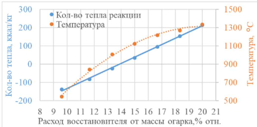
Рисунок 3.14 – Зависимость теплового эффекта и температуры обжига от процента твердого восстановителя при концентрации в отходящих газах CO=1,5% об.
