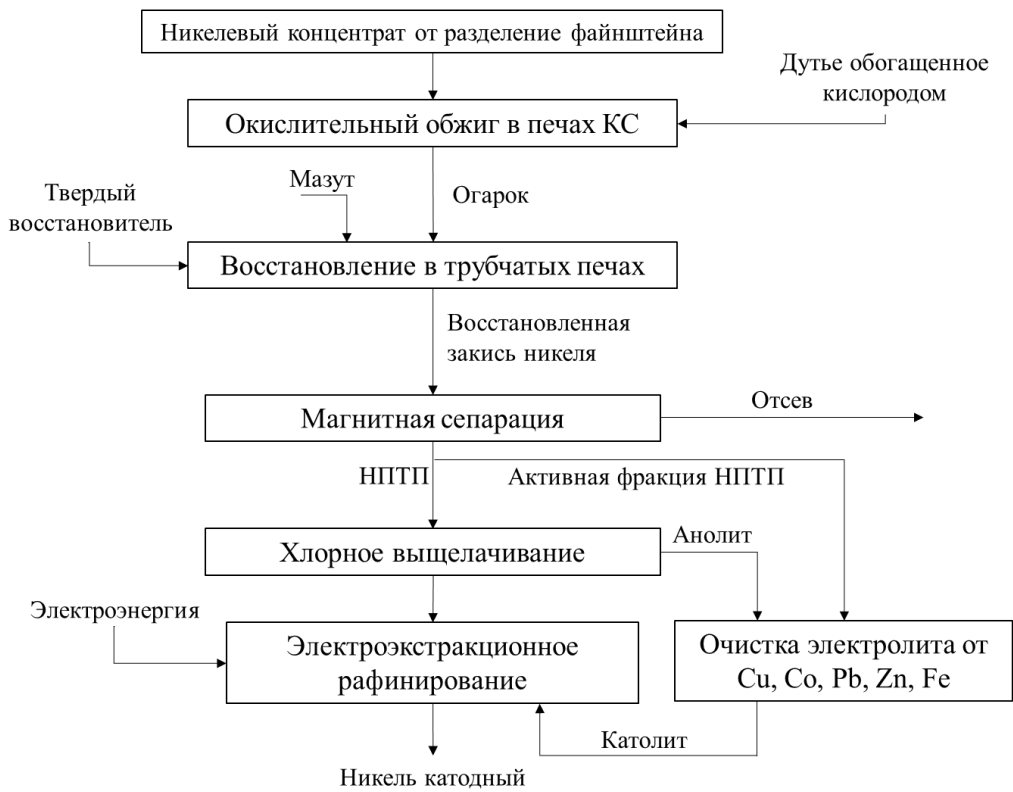
Рисунок 1.2 – Технологические схемы переработки никелевого концентрата на КГМК.
