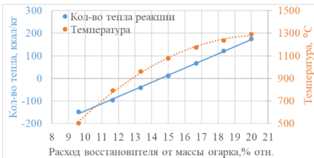
Рисунок 3.15 – Зависимость теплового эффекта и температуры обжига от процента твердого восстановителя при концентрации в отходящих газах \text{CO}=3\% об.
