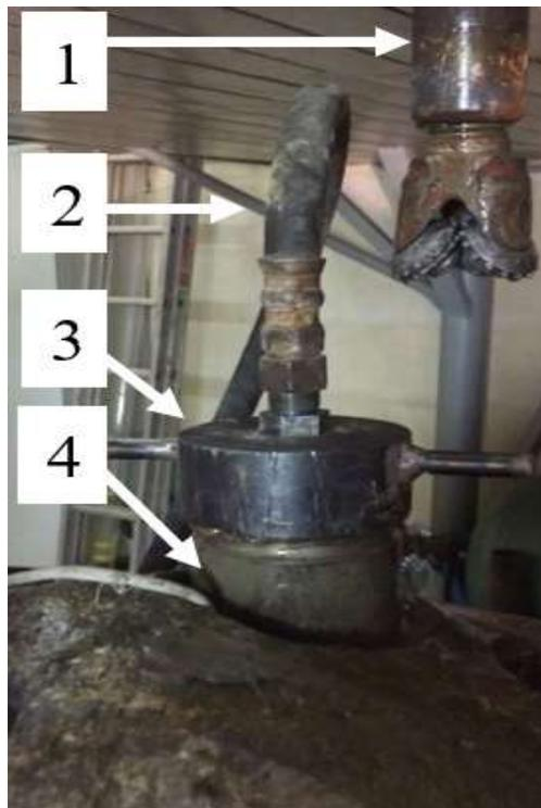
Рисунок 3.11 – Общий вид стенда при проведении опрессовки: 1 - долото, 2 – рукав высокого давления, 3 – герметичный переводник, 4 – зацементированная обсадная труба
