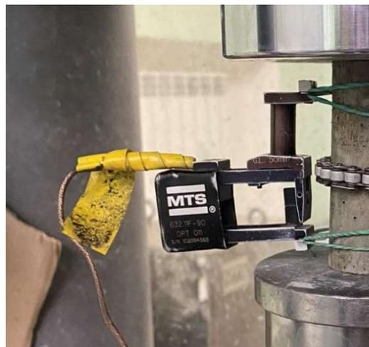
Рисунок 2.9 – Использование продольного экстензометра на практике
