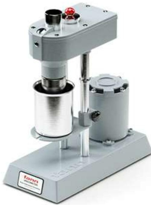
Рисунок 2.1 – Ротационный вискозиметр
