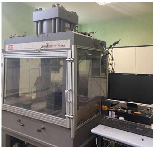
Рисунок 2.6 – Испытательная система MTS Direct Shear Test Systems
