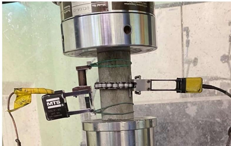
Рисунок 2.14 - Установка для одновременного двойного измерения продольной деформации и измерения круговой деформации на практике
