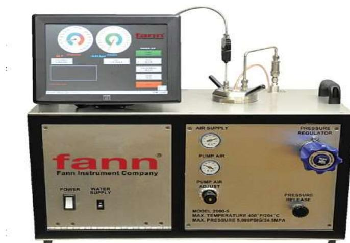
Рисунок 2.5 – Ультразвуковой анализатор прочности цементного раствора
