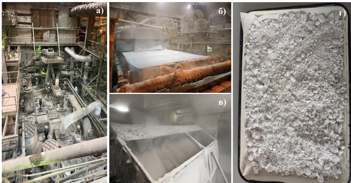
Рисунок 2.1 – Отбор проб фосфогипса: а) цех производства ЭФК; б) ленточный конвейер ФДГ; в) узел отгрузки ФПГ; г) проба ФДГ
