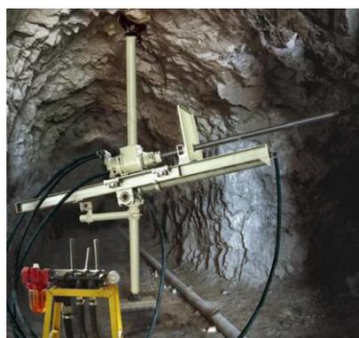
Рисунок 1.3– Машины для ударно-поворотного бурения инструментом безлезвийного типа (составлено автором)
