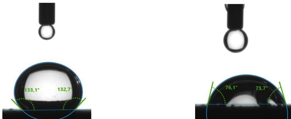
Рисунок 3.11 – Первая и вторая капля модельного фильтрата с добавлением ПАВ № 14, 1,5 % на поверхности горной породы (составлено автором)
