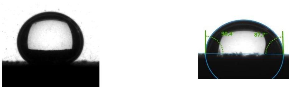
Рисунок 3.15 – Первая и вторая капля модельного фильтрата с добавлением ПАВ № 24, 0,5 % на поверхности горной породы (составлено автором)
