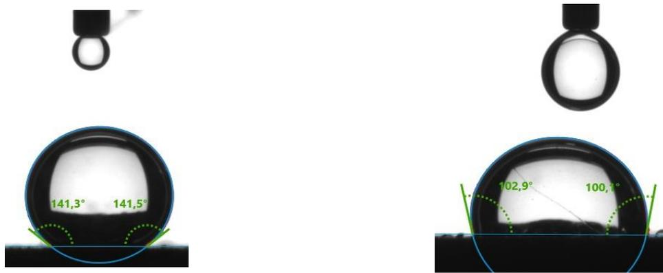
Рисунок 3.9 – Первая и вторая капля модельного фильтрата с добавлением ПАВ № 14, 0,5 % на поверхности горной породы (составлено автором)
