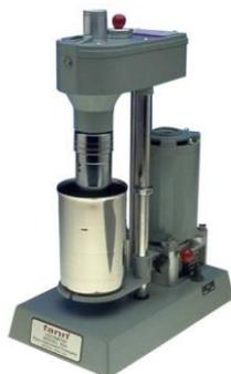
Рисунок 2.6 – Шестискоростной вискозиметр FANN 35SA для определения реологических свойств буровых растворов (составлено автором)
