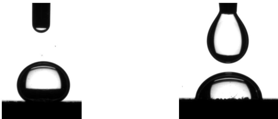
Рисунок 3.13 – Первая и вторая капля модельного фильтрата с добавлением ПАВ № 23, 1 % на поверхности горной породы (составлено автором)
