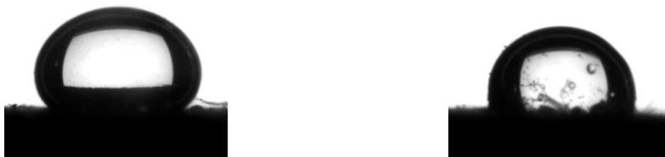
Рисунок 3.16 – Первая и вторая капля модельного фильтрата с добавлением ПАВ № 24, 1 % на поверхности горной породы (составлено автором)
