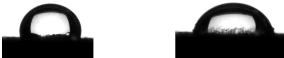
Рисунок 3.17 – Первая и вторая капля модельного фильтрата с добавлением ПАВ № 24, 1,5 % на поверхности горной породы (составлено автором)
