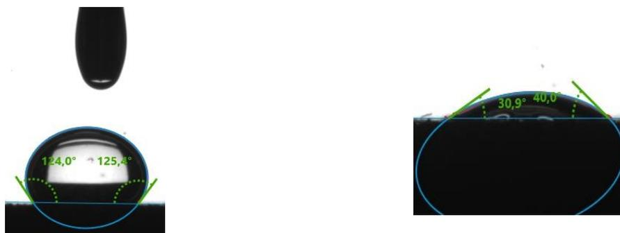
Рисунок 3.14 – Первая и вторая капля модельного фильтрата с добавлением ПАВ № 23, 1,5 % на поверхности горной породы (составлено автором)
