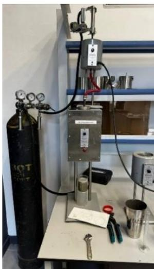
Рисунок 3.30 – Определение кольтатирующей способности буровых растворов при помощи двух фильтр-прессов (составлено автором)
