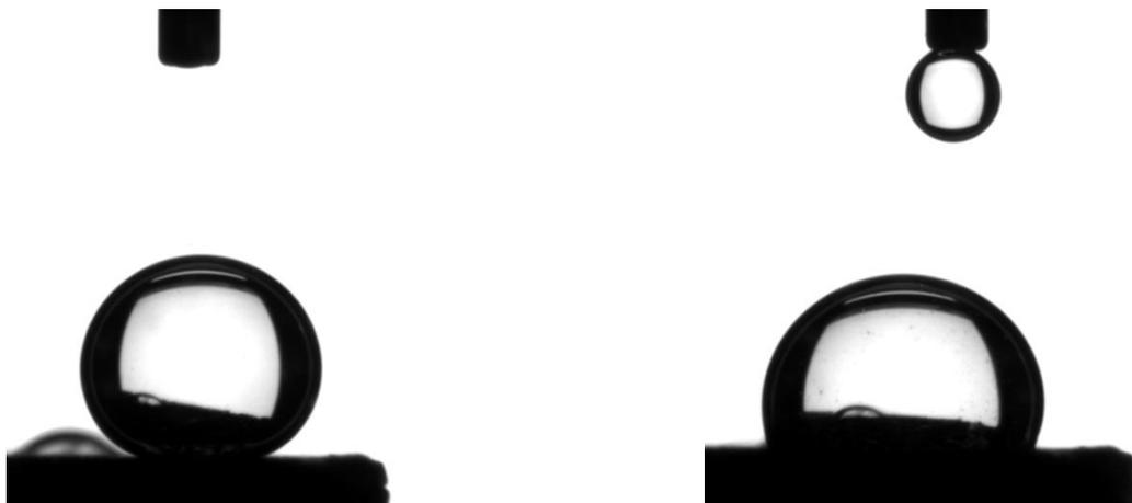
Рисунок 3.10 – Первая и вторая капля модельного фильтрата с добавлением ПАВ № 14, 1 % на поверхности горной породы (составлено автором)
