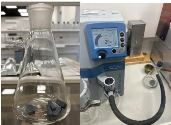
Рисунок 3.5 – Процесс создания модели нефтенасыщенной горной породы при помощи вакуумного насоса (составлено автором)
