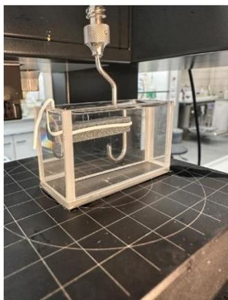
Рисунок 3.18 – Процесс измерения всплывающей капли керосина в водной среде (составлено автором)
