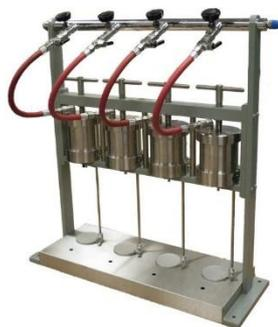
Рисунок 2.7 – Фильтр-пресс для определения показателя водоотдачи буровых растворов при низких температурах и низком давлении
