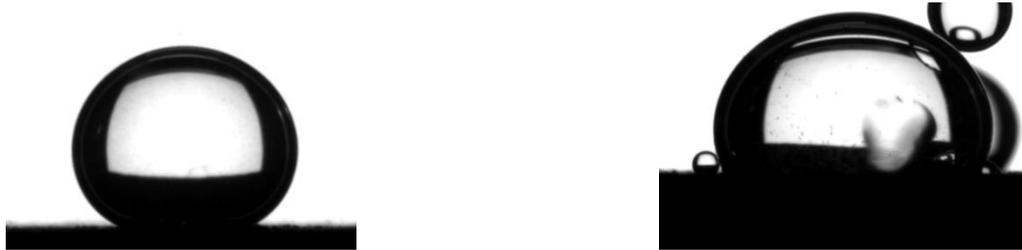
Рисунок 3.8 – Первая и вторая капля модельного фильтрата с добавлением ПАВ № 14, 0,5 % на поверхности горной породы (составлено автором)
