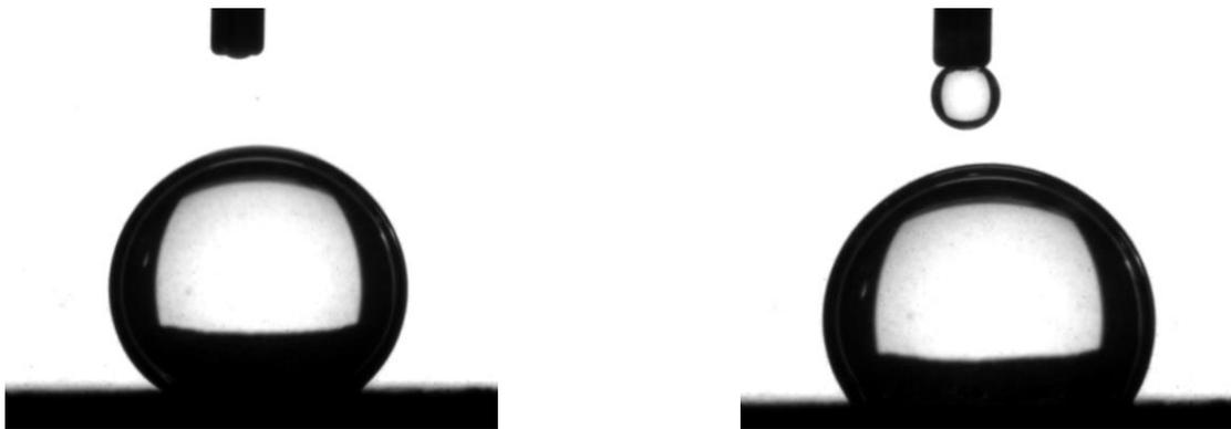
Рисунок 3.7 – Капля воды на поверхности горной породы в первую минуту и через 6 часов (составлено автором)
