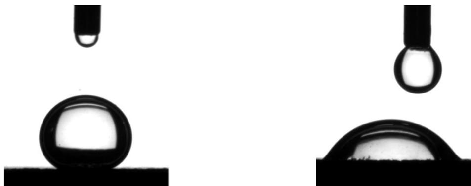
Рисунок 3.12 – Первая и вторая капля модельного фильтрата с добавлением ПАВ № 23, 0,5 % на поверхности горной породы (составлено автором)
