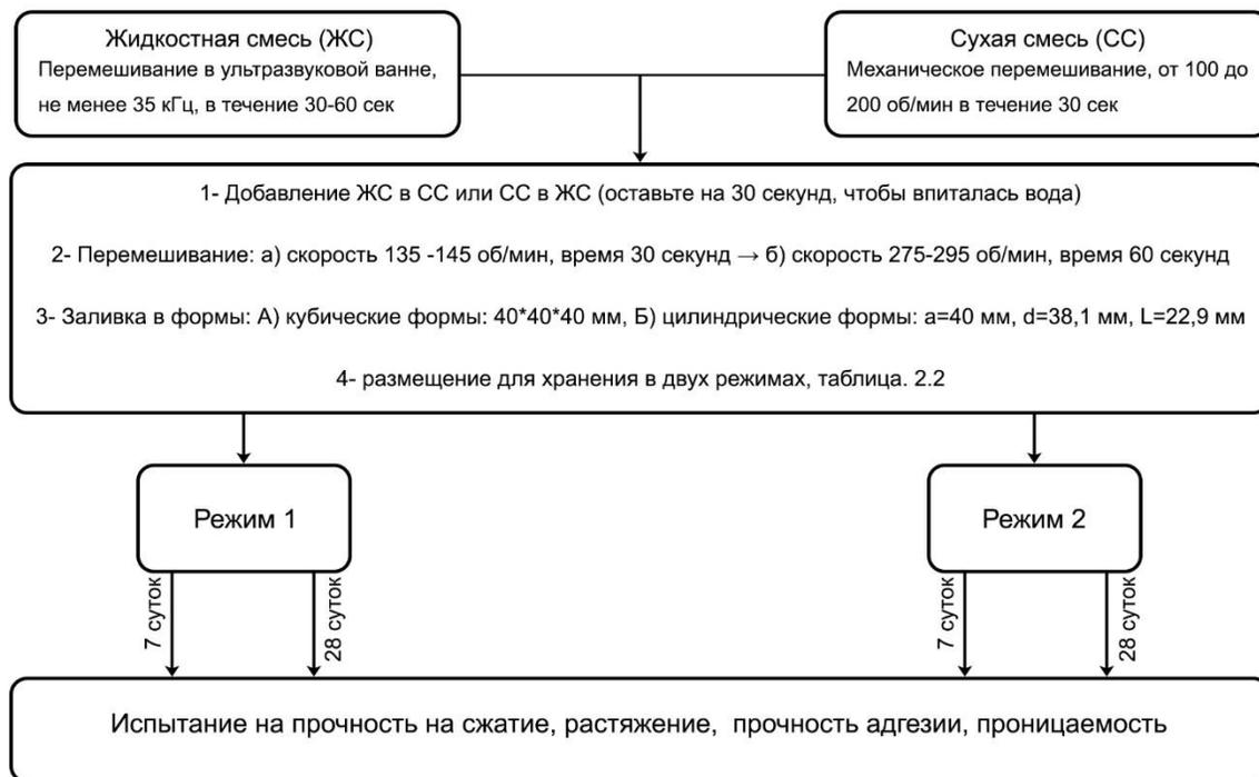
Рисунок 2.6 – Блок-схема, обобщающая методологию исследования
