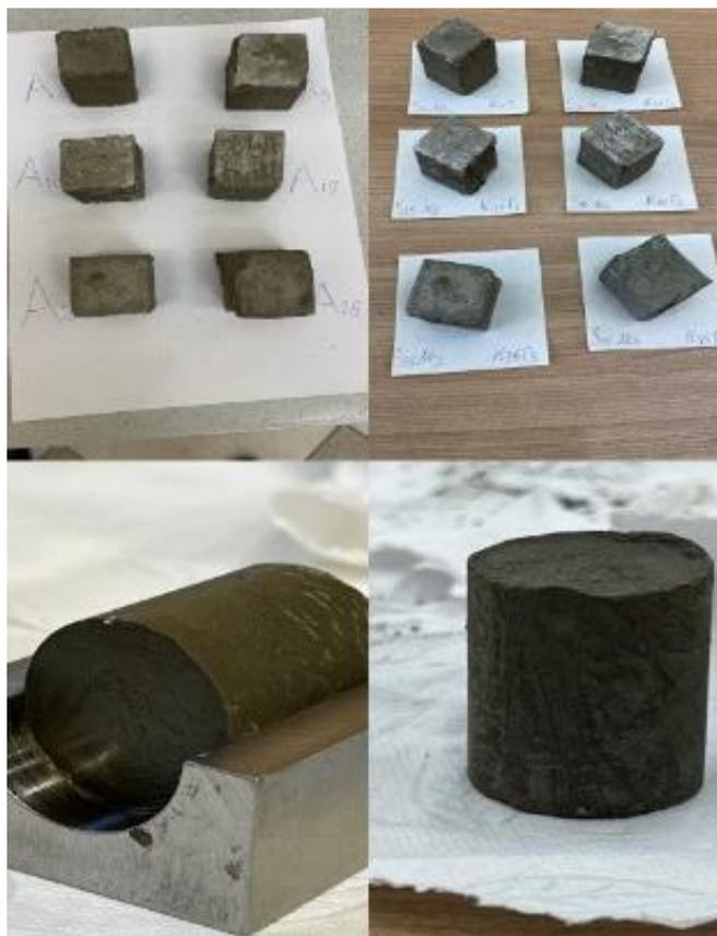
Рисунок 2.7 – Кубические и цилиндрические образцы, использованные в исследовании (фото автора)
