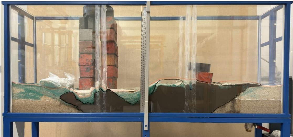
Рисунок 2.23 – Лабораторные исследования характера развития совместных деформаций сыпучего материала и глинисто-солевых шламов в лабораторном стенде (а – начало эксперимента; б – внедрение сыпучего материала в момент проведения эксперимента; в – внедрение сыпучего материала спустя двое суток после окончания эксперимента)
