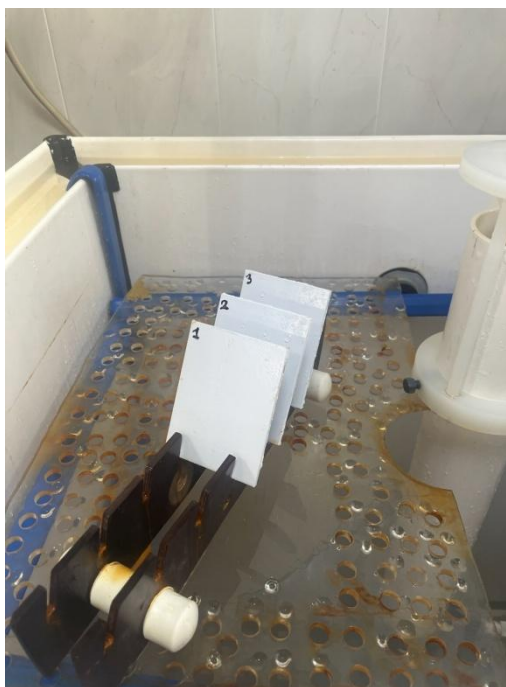
Рисунок 4.12 – Образцы в камере соляного тумана после испытания [фото автора]
