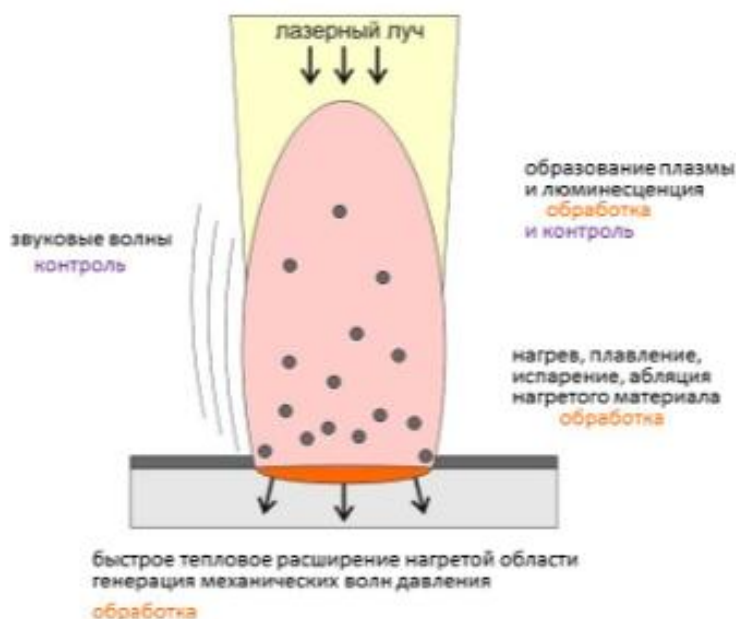
Рисунок 1.7 – Общая схема процессов воздействия лазерного излучения на поверхность [8]
