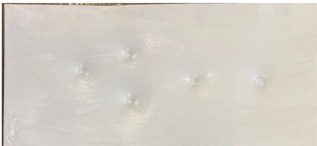
Рисунок 4.1 – Пример образца, покрытого фторопластовым покрытием, после проведения испытаний [фото автора]
