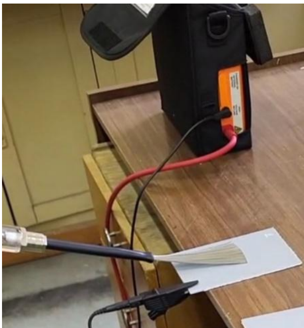
Рисунок 4.14 – Пример испытания образца на сплошность покрытия электроискровым методом дефектоскопом марки Elcometer 236 [фото автора]
