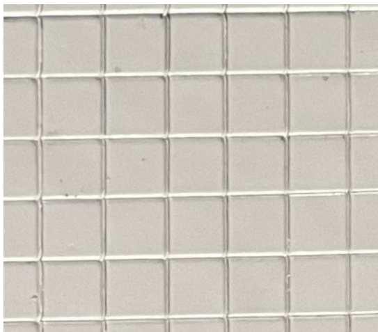
Рисунок 3.6 – Решётка надрез при испытании на адгезию [фото автора]
