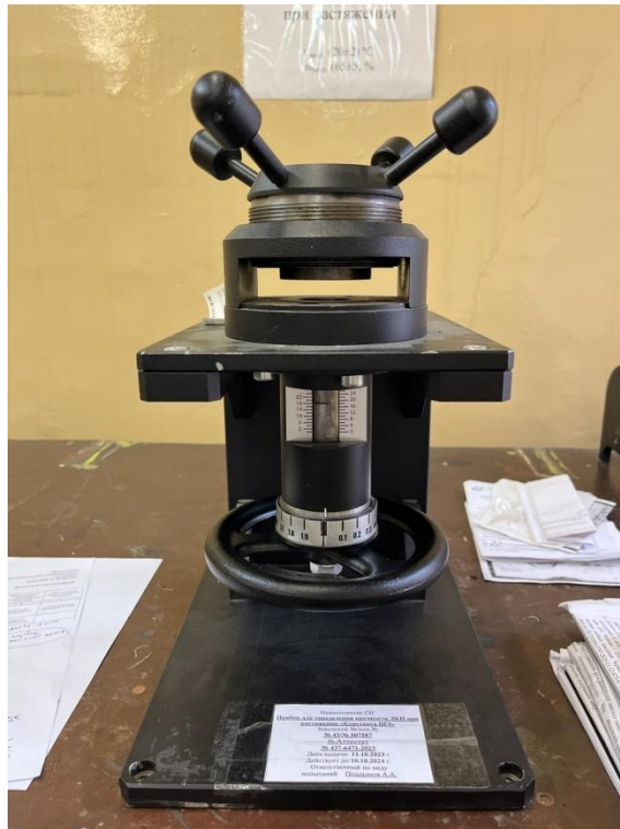
Рисунок 2.7 – Прибор «Константа-ШЭ» [фото автора]
