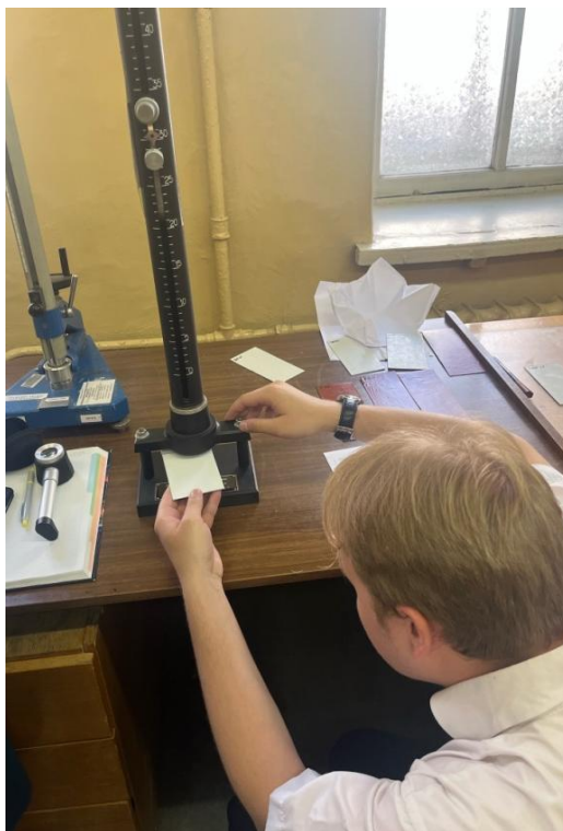
Рисунок 2.6 – Проведение опыта на ударную прочность покрытия на приборе «Константа-У1» [фото автора]
