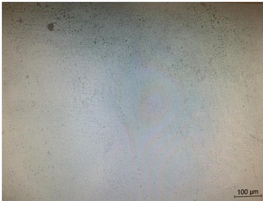
Рисунок 4.7 – Поверхность образца с фторопластовым покрытием после выдержки при - (60 \pm 3) °С в течение 24 часов [фото автора]
