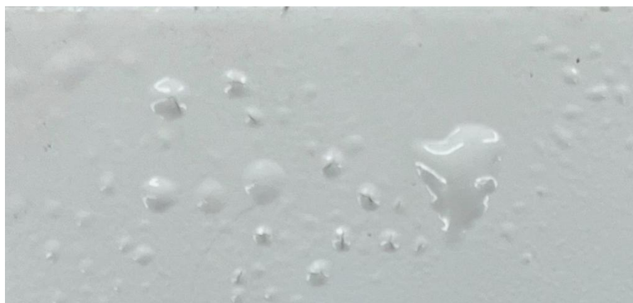
Рисунок 4.8 – Пример блистеров на покрытии после проведения испытаний (макрофотография участка поверхности) [фото автора]
