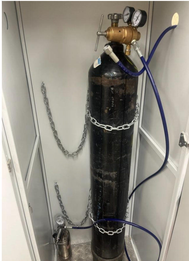
Рисунок 2.11 – Внешний вид ячейки, подключённой к газовому баллону для проведения исследований [фото автора]
