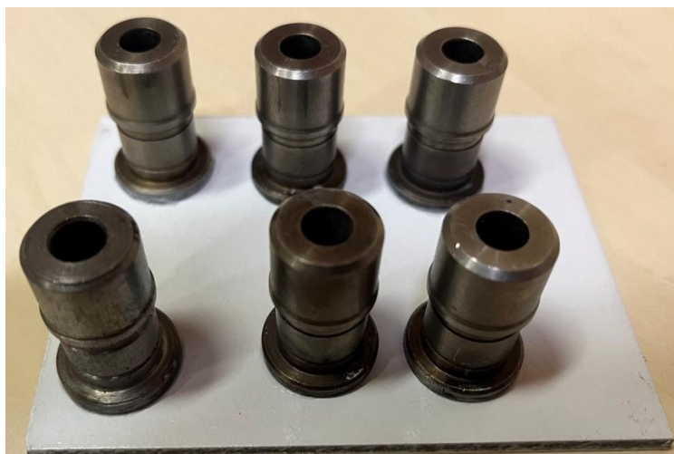
Рисунок 2.5 – Образец перед проведением испытаний с приклеенными «грибками» [фото автора]
