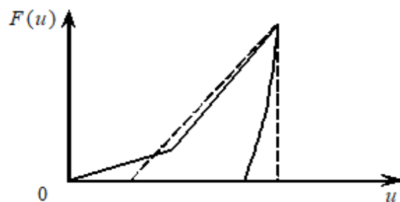
Рисунок 1.22 Зависимость сила – внедрение по В.М. Ливенштейну [30]
