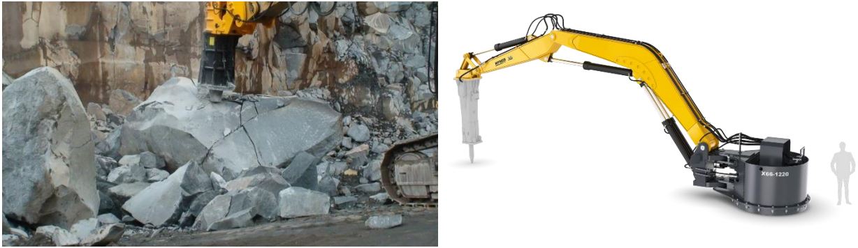
Рисунок 1.7 – Гидравлический бутобой, где: а – на экскаваторе, б – стационарный [48]
