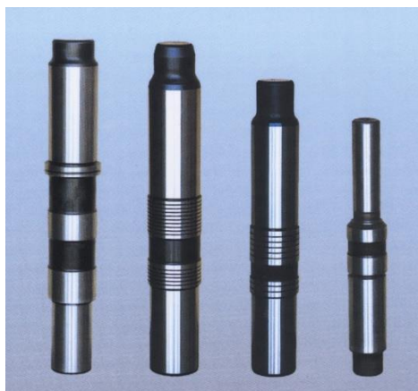
Рисунок 1.13 – Типовые формы бойков гидромолотов [2]
