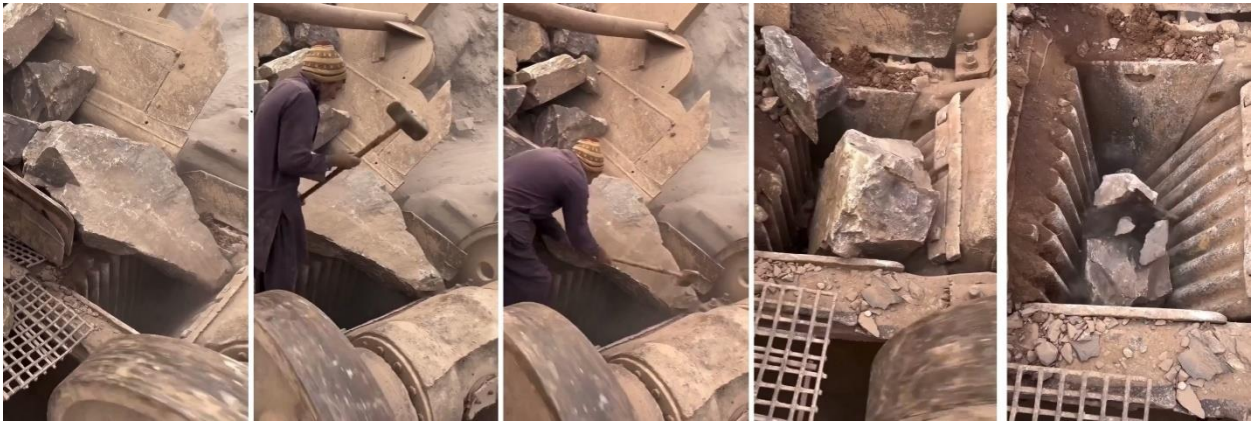
Рисунок 1.3 – Попадание негабарита в зев дробилки (составлено автором)
