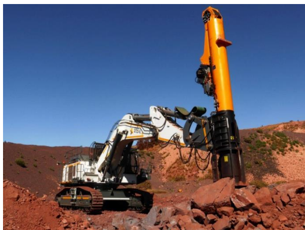
Рисунок 1.8 – Дизельмолот разрушающий негабарит [50]
