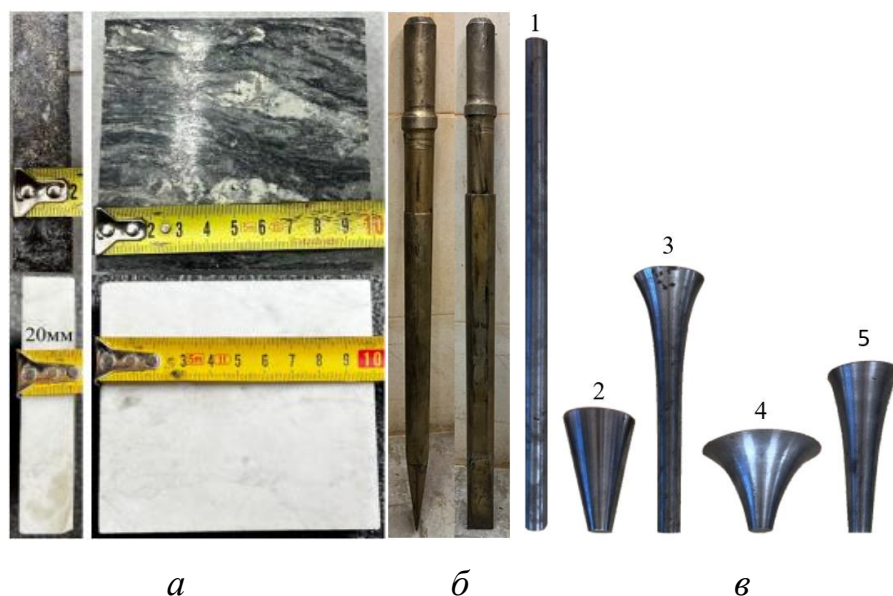
Рисунок 3.3 – Опытные образцы: а – горная порода, б – пика, в – бойки (составлено автором)
