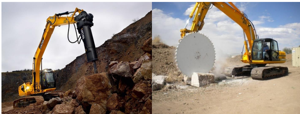
Рисунок 1.4 – Механические способы разрушения негабаритов: а – ударное разрушение, б – разрушение резанием [47]
