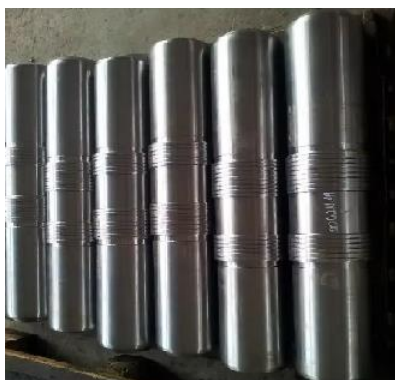
Рисунок 2.6 – Стандартный боёк гидромолота [2]
