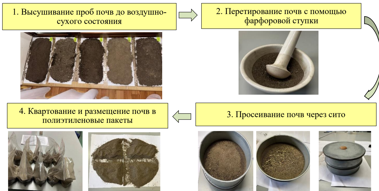
Рисунок 15 – Подготовка проб почв для лабораторного анализа
