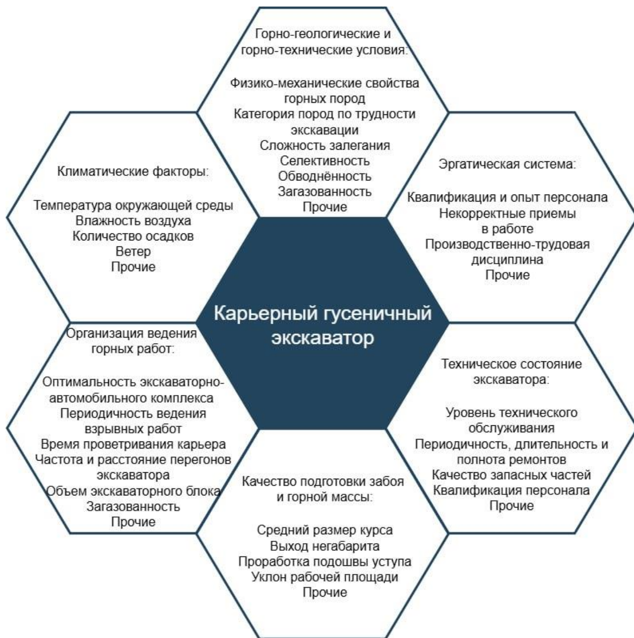
Рисунок 1.1 – Факторы, влияющие на работоспособность и производительность карьерного экскаватора цикличного действия (составлено автором)
