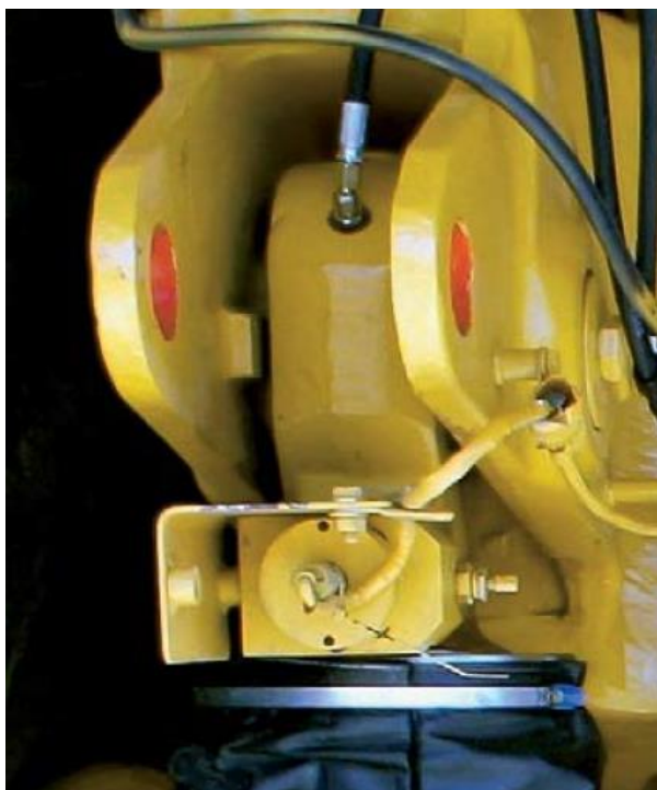
Рисунок 2.9 – Крепление датчика давления системы СКЗиТ к цилиндру задней подвески (фото автора)
