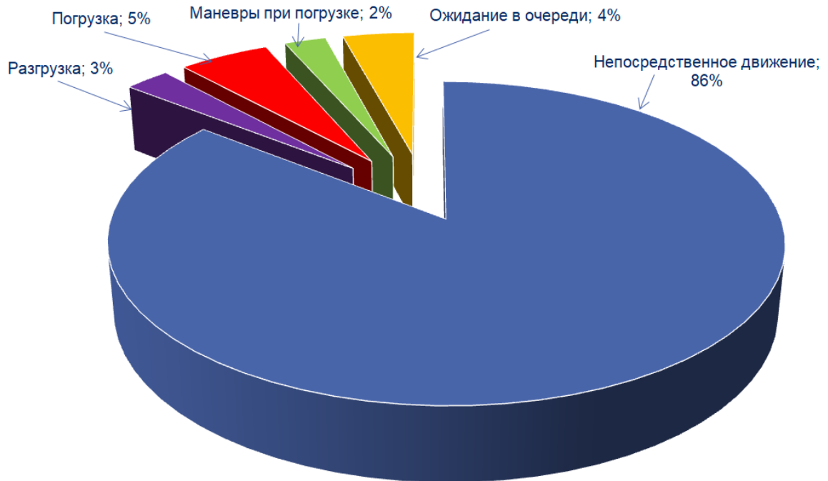
Рисунок 1.2 – Удельный по времени вес технологических операций в общей структуре рейса автосамосвала на Ломоносовском ГОКе АО «Севералмаз» [109]
