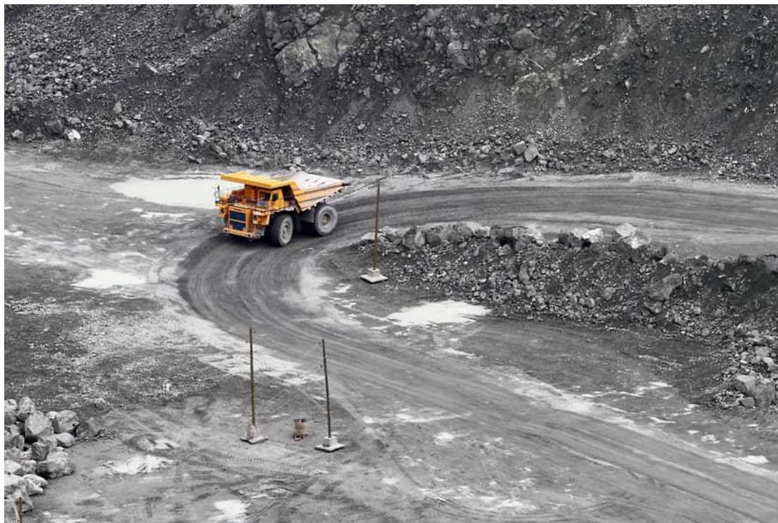
Рисунок 2.2 – Поворот технологической трассы малого радиуса на карьере «Северный» Качканарского ГОКа [16]
