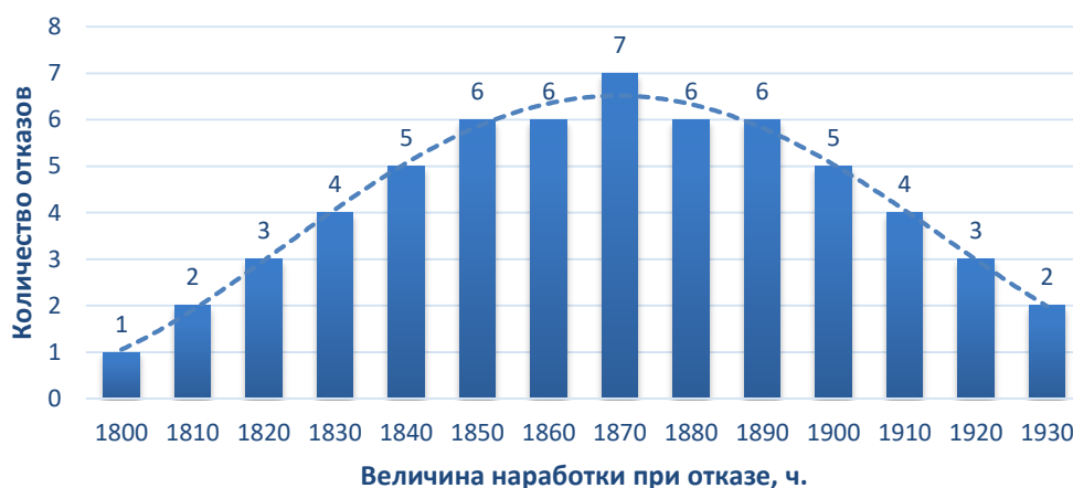
Рисунок 3.9 – Гистограмма распределения отказов подвески автосамосвалов модели БЕЛАЗ-7530 на Качканарском ГОКе (составлено автором)
