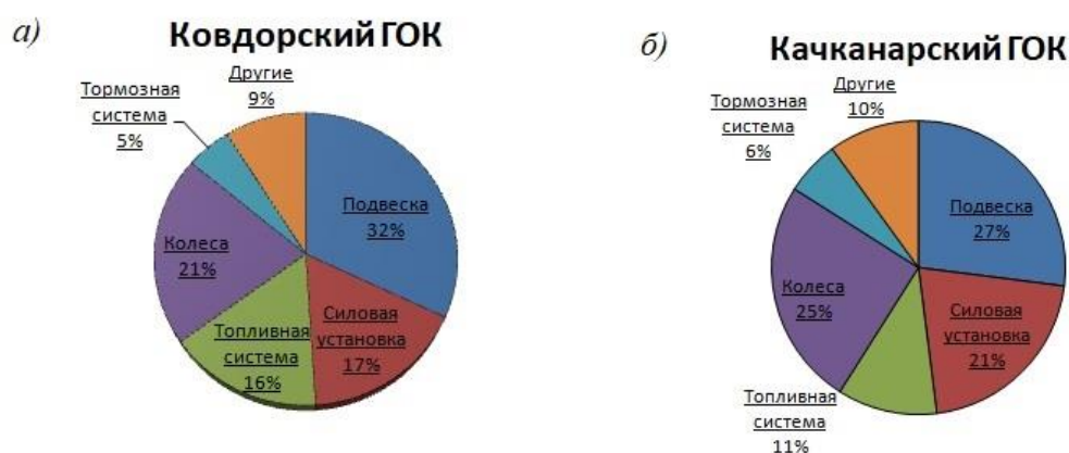
Рисунок 2.5 – Узлы и агрегаты карьерных автосамосвалов, участвующих в исследовании, с наибольшим числом отказов на: а) АО «Ковдорский ГОК», б) «ЕВРАЗ Качканарский ГОК» (составлено автором)
