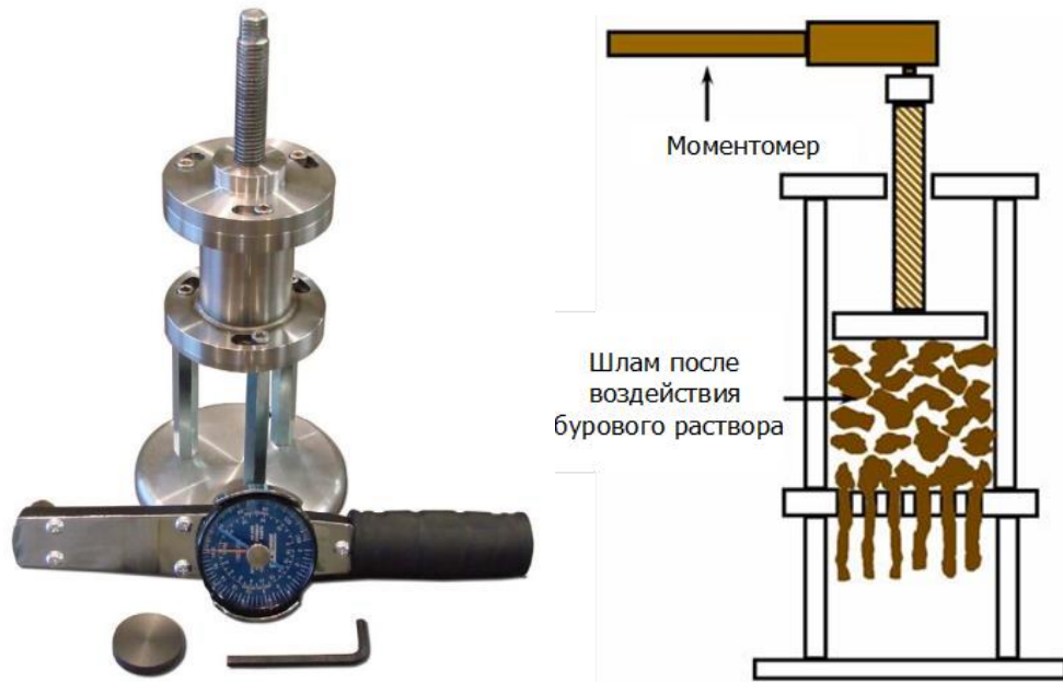
Рисунок 2.5 – Устройство Bulk Hardness Test и схема его работы (составлено автором)
