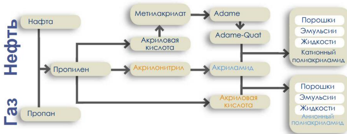
Рисунок 6 – Процесс производства ПАА из сырых материалов [28]
