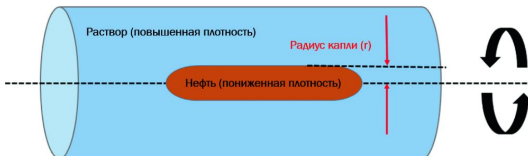
Рисунок 29 – Вращение капли нефти в объеме жидкости для определения МФН (составлено автором)
