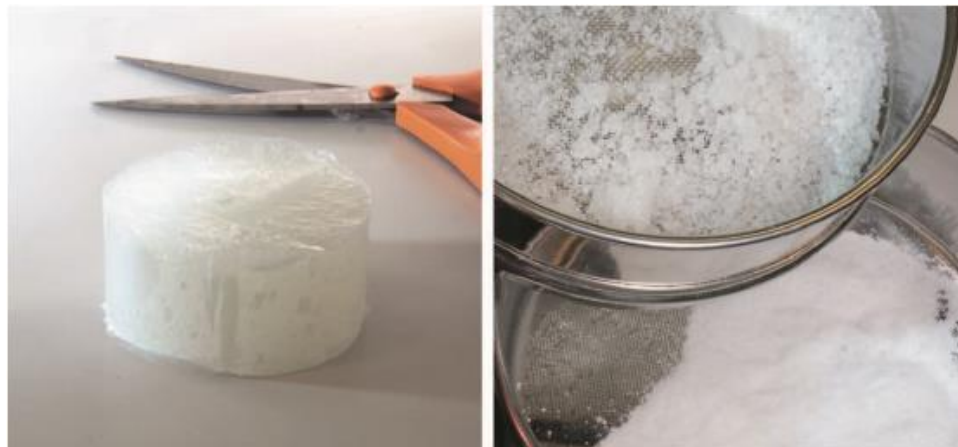
Рисунок 8 – Процесс гелевой полимеризации: слева – блок полимера после гелевой полимеризации; справа- порошок после сушки и измельчения геля [39]
