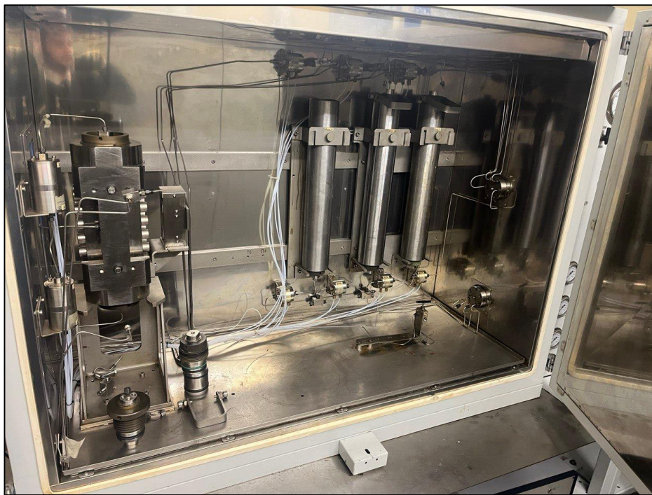
Рисунок 25 – Внешний вид установки Autoflood 700 (Vinci Technologies) (фото автора)
