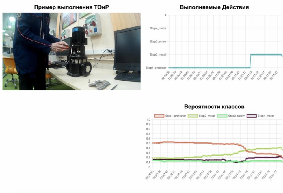
Рисунок 4.2 – Веб-интерфейс с отображением работы модели классификации действий ТОиР центробежного насоса (составлено автором)
