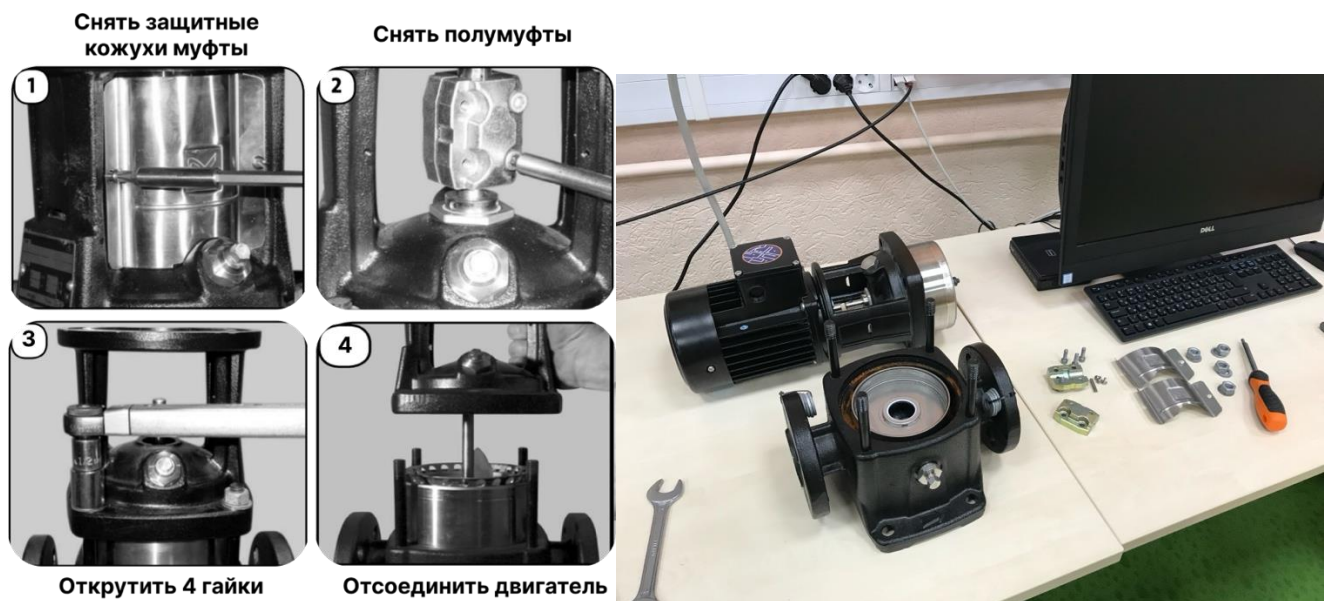
Рисунок 3.1 – Действия по ТОиР центробежного насоса, выполняемые во время лабораторного эксперимента (слева), центробежный насос в лаборатории (справа) (составлено автором)
