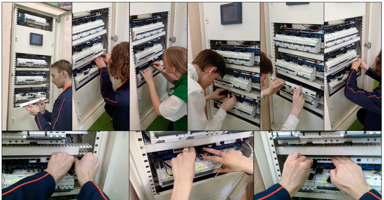
Рисунок 3.13 – Пример выполнения замены устройства SmartLink в ходе лабораторного эксперимента (составлено автором)
