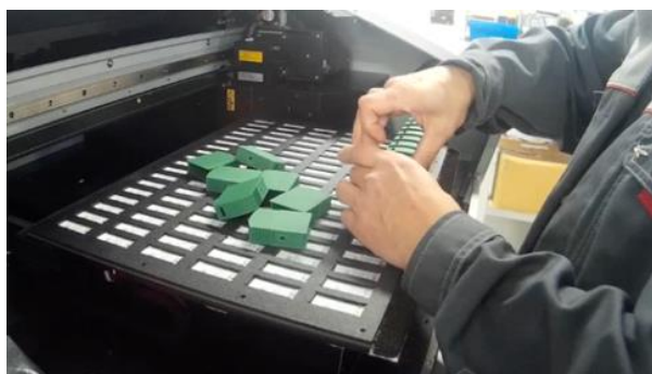
Вставка детали в матрицу принтера
