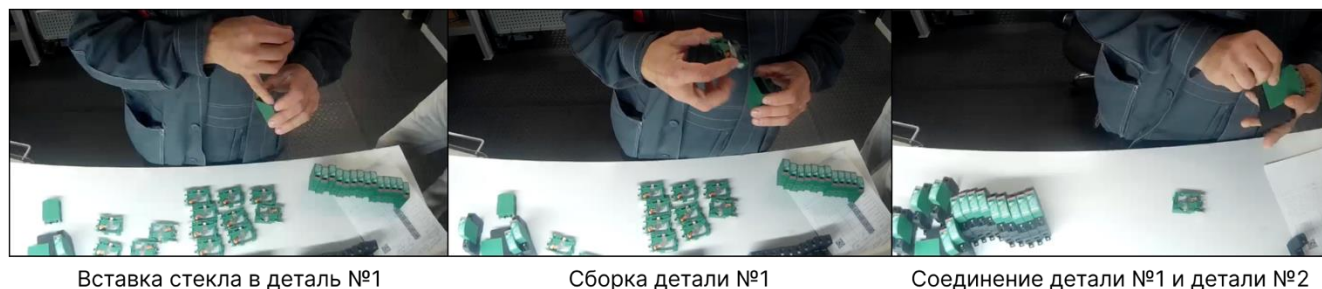
Рисунок 3.23 – Действия по сборке устройств защиты от импульсных перенапряжений (составлено автором)
