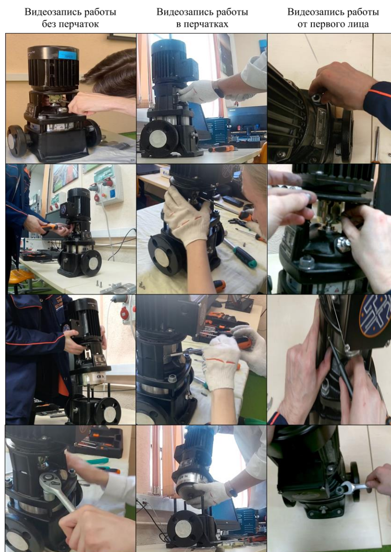
Рисунок 3.2 – Примеры видеозаписи действий во время эксперимента с центробежным насосом (фото автора)
