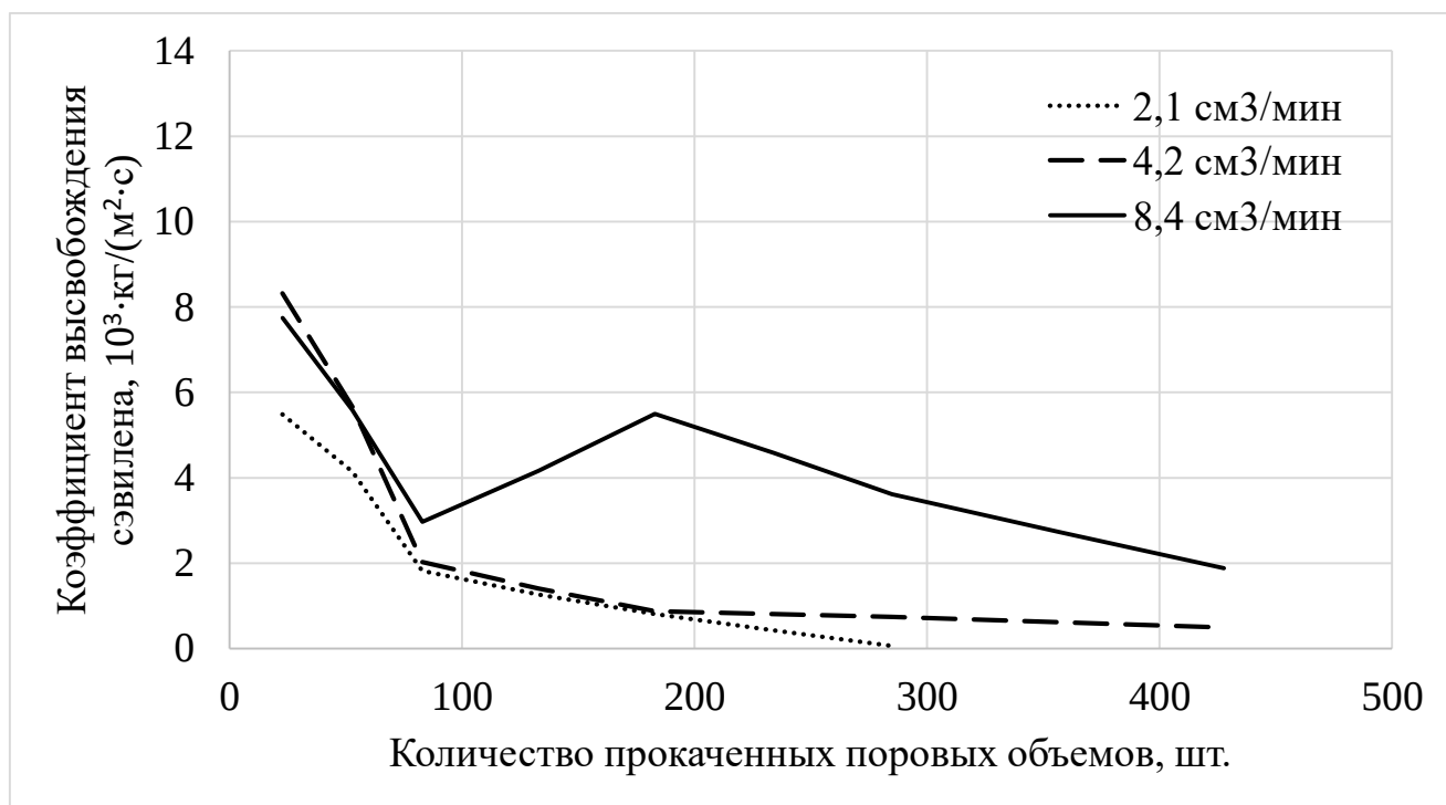
Рисунок 3.18 – Зависимость коэффициента высвобождения сэвилена от прокаченного объема нефти через модельную пачку при различном расходе (составлено автором)
