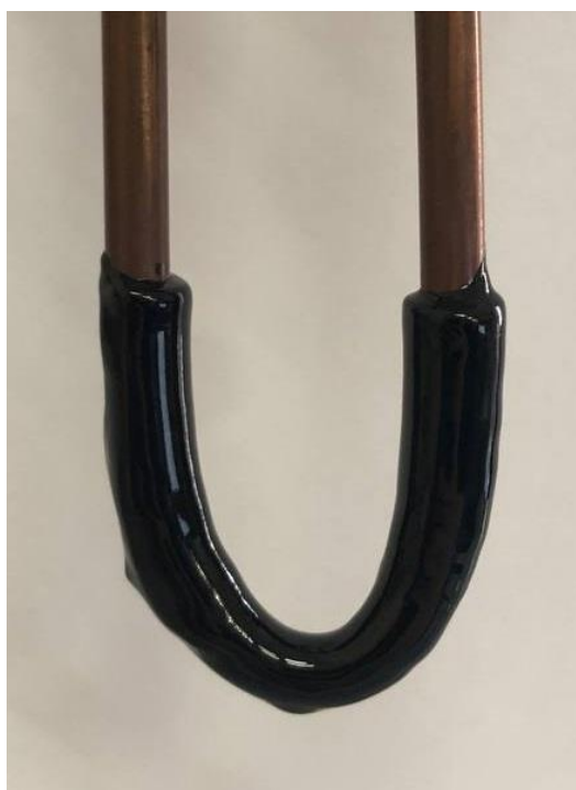
Рисунок 2.14 – Внешний вид покрытого отложениями стержня после эксперимента при концентрации сэвилена 0,01% масс. (фото автора)
