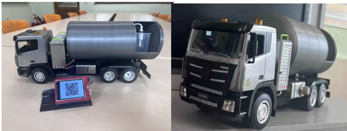
Рисунок 4.2 – Макет системы удаленного мониторинга состояния опасных грузов на основе матричного QR-кода [составлено автором]
