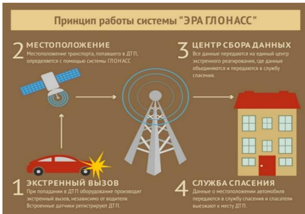
Рисунок 1.12 – Принцип работы система «ЭРА–ГЛОНАСС» [101]
