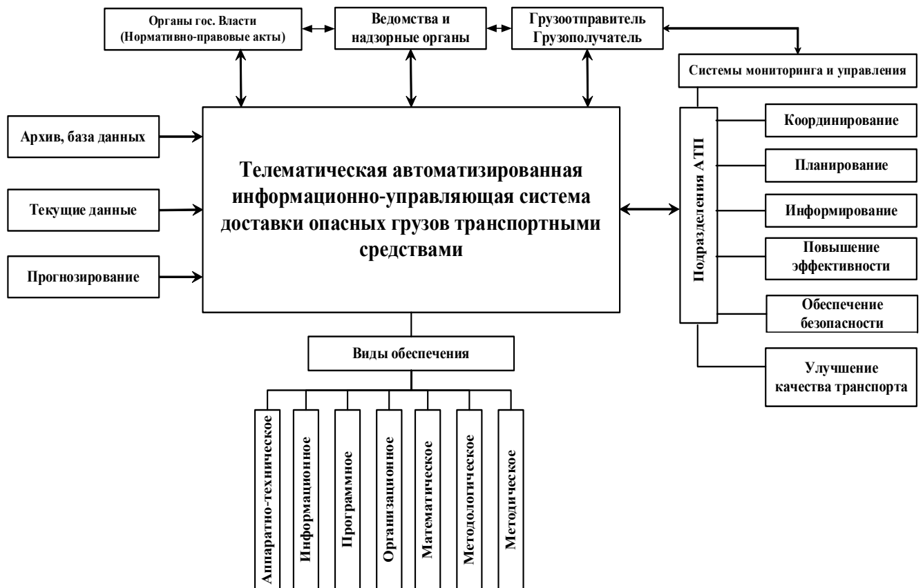
Рисунок 2.5 – Обобщенная модель построения ТАИУС ДОГ ТС [составлено автором]
