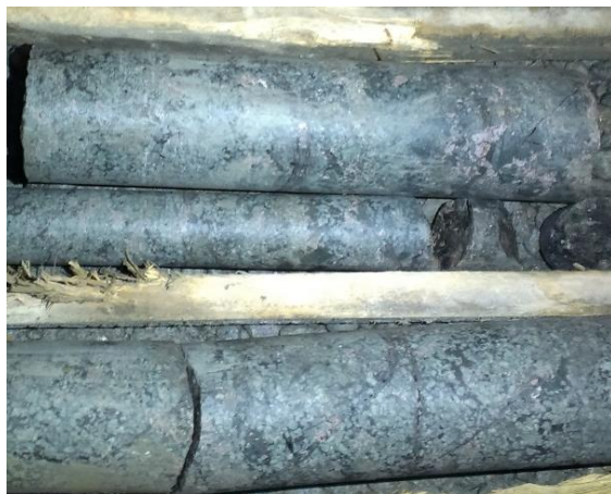
Рисунок 2.5 – Состояние керна; а – без видимых повреждений; б – кольцевание (высокие действующие напряжения)
