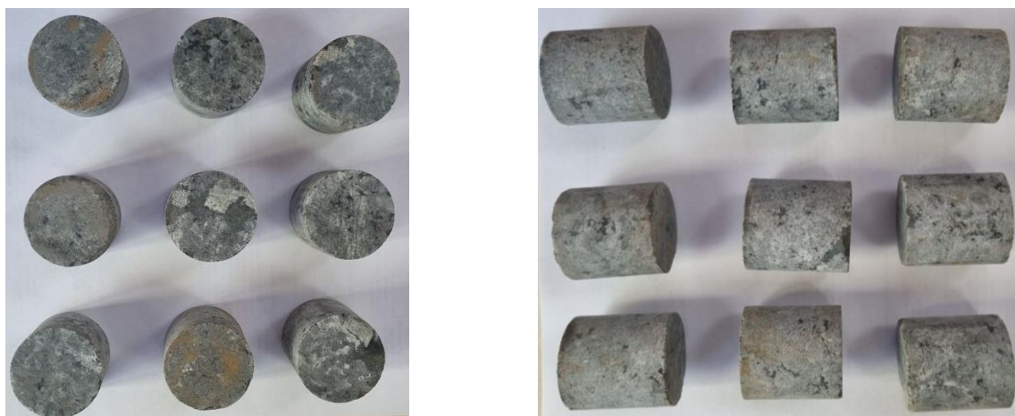
Рисунок 3.12 – Образцы кернового материала для проведения испытаний при срезе со сжатием
