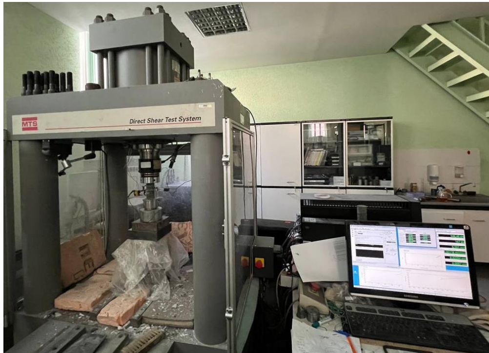
Рисунок 2.12 – Сервогидравлическая испытательная система MTS 816 (MTS, США) (модификация для испытаний на одноосное сжатие)
