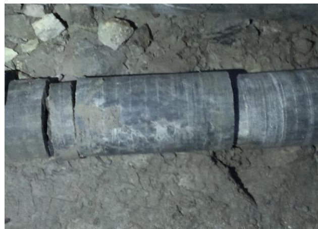
Рисунок 2.5 – Состояние керна; а – без видимых повреждений; б – кольцевание (высокие действующие напряжения)
