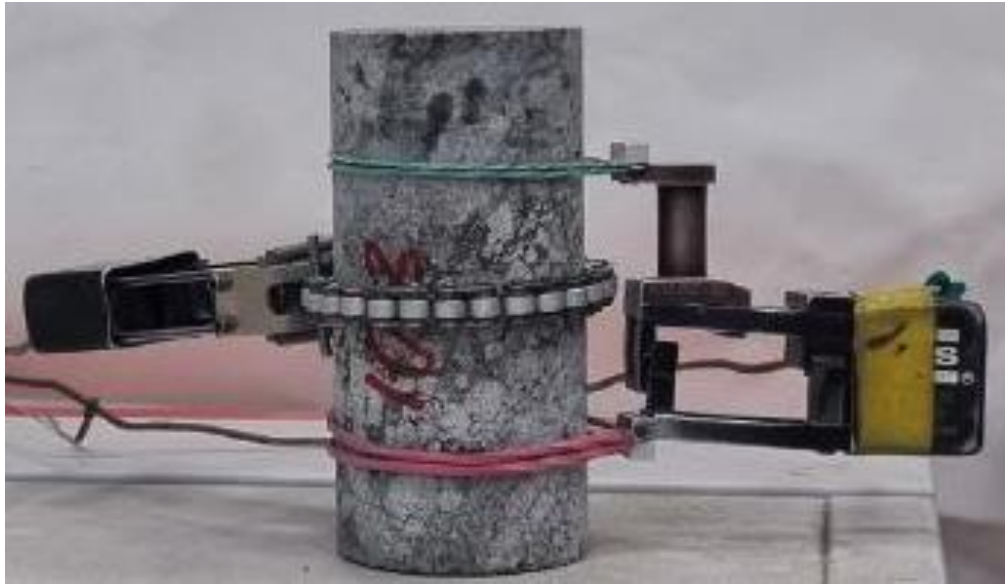
Рисунок 2.13 – Расположение продольных деформометров относительно образца горной породы
