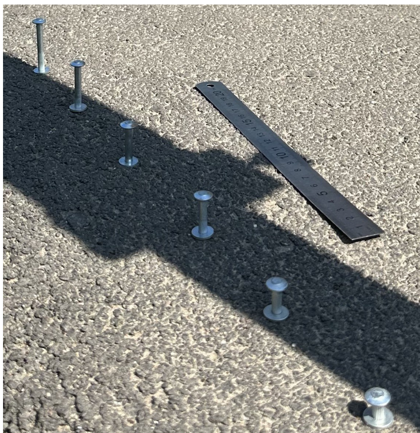
Рисунок 17 – Закреплённые в твёрдом покрытии дюбели с целью моделирования смещений деформационного пункта в теле оползня
