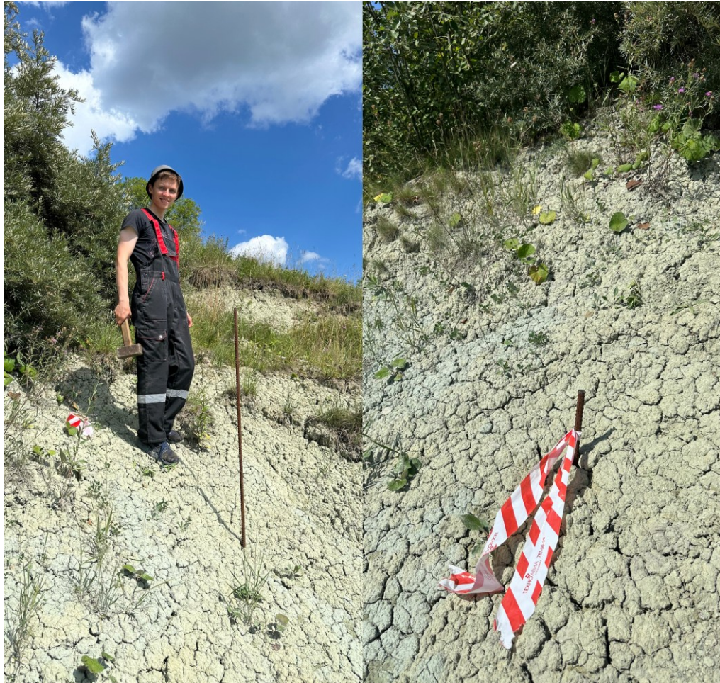
Рисунок 31 – Процесс закрепления деформационного пункта на оползневом склоне левого берега реки Тосны
