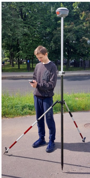
Рисунок 18 – Процесс определения положения дюбелей технологией RTK
