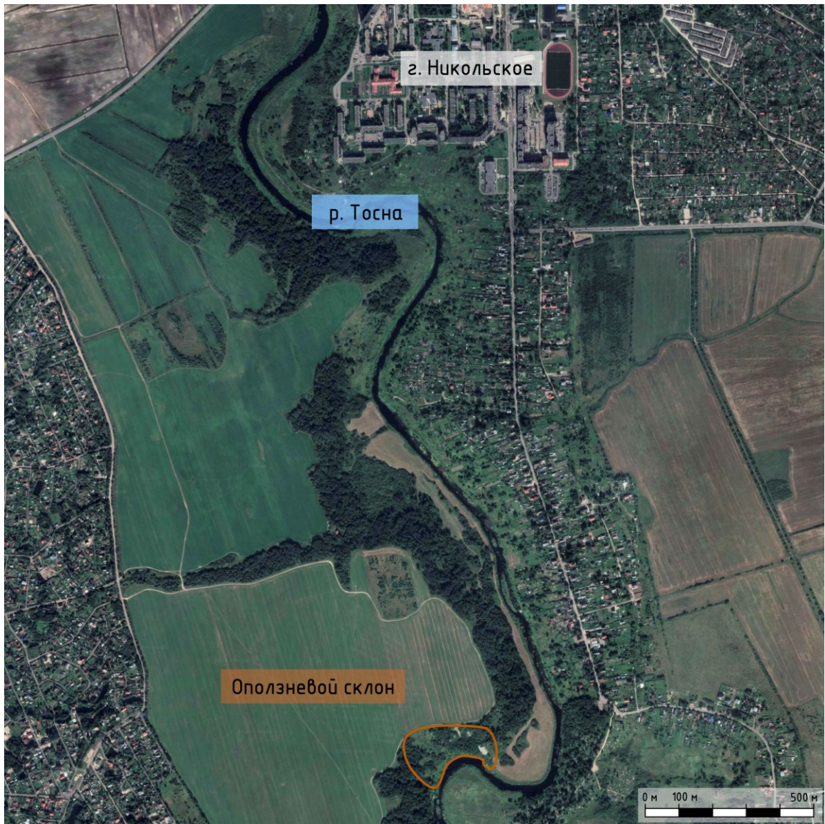
Рисунок 28 – Схема расположения оползневого склона левого берега реки Тосны
