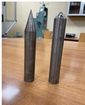
Рисунок 3.2 - Пики с разными углами заострения (фото автора)
