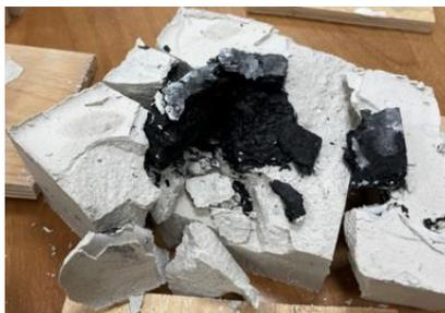
Рисунок 3.6 - фотографии образцов в напряженном состоянии после разрушения пикой  $90^\circ$  (фото автора)
