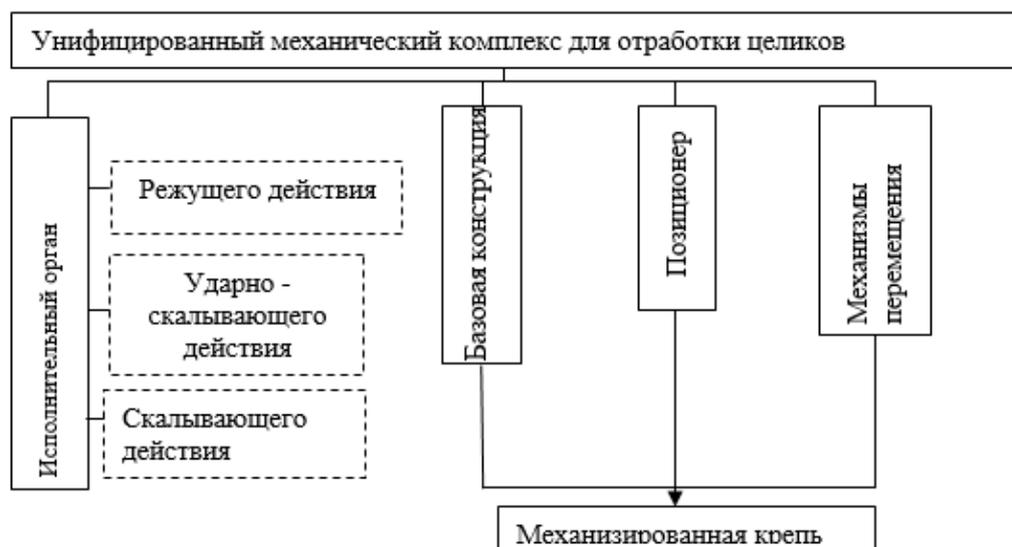
Рисунок 2.5 - Структура унифицированного механизированного комплекса для отработки целиков угольных шахт (составлено автором)
