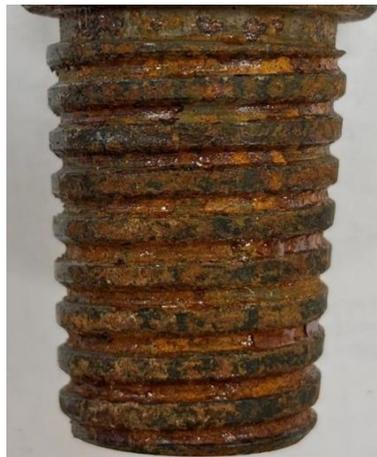
Рисунок 4.2 – Результаты коррозионных испытаний в камере соляного тумана образцов с наружной резьбой из стали 40Х, не обработанных магнитно-абразивной обработкой
