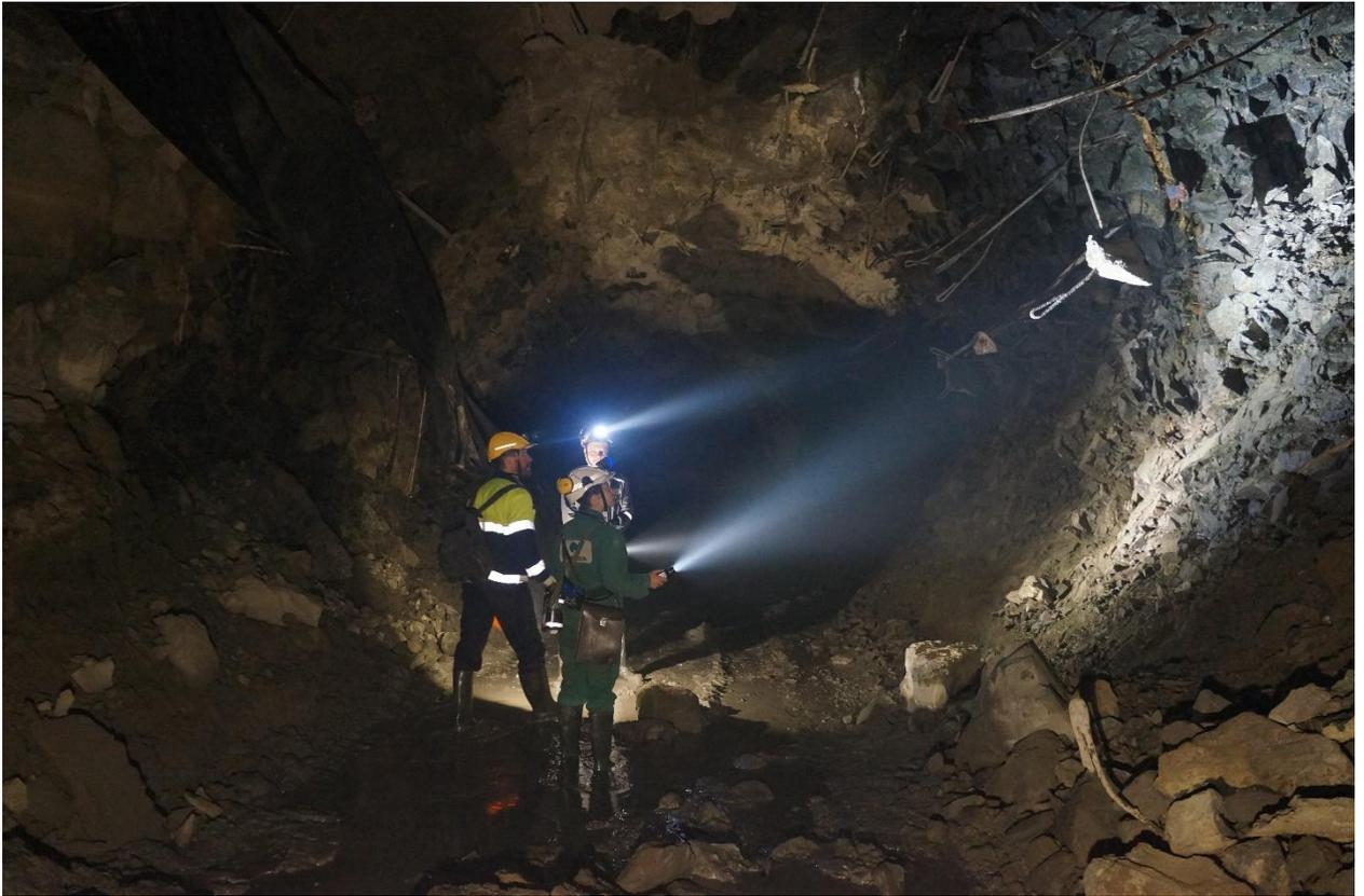
Рисунок А.7 - Картирование горных выработок (нарезные выработки)
