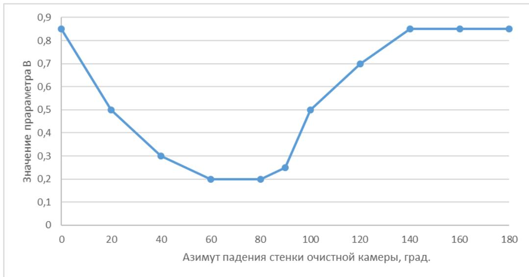
Рисунок 3.29 - График зависимости величины параметра В от ориентации стенки очистной выработки
