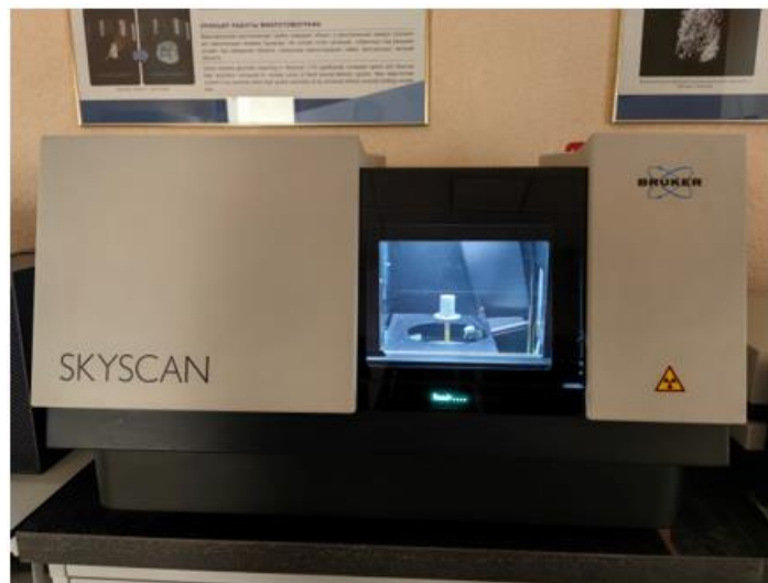
Рисунок 2.5 – Рентгеновский сканер для микротомографии SkyScan 1173 (Bruker)
