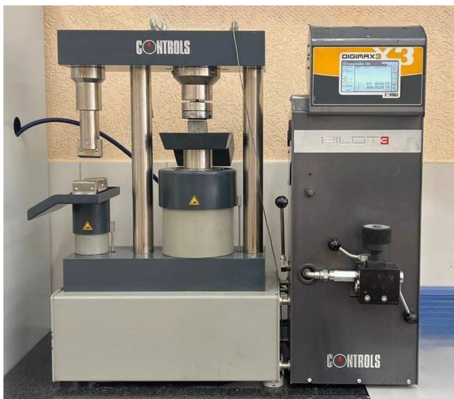
Рисунок 2.3 – Гидравлический пресс Controls Pilot 3 для испытания образцов на сжатие и изгиб
