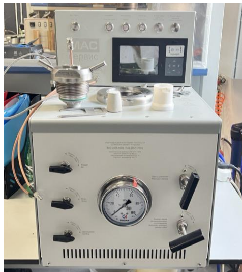
Рисунок 2.4 – Ультразвуковой анализатор прочности цементного раствора
