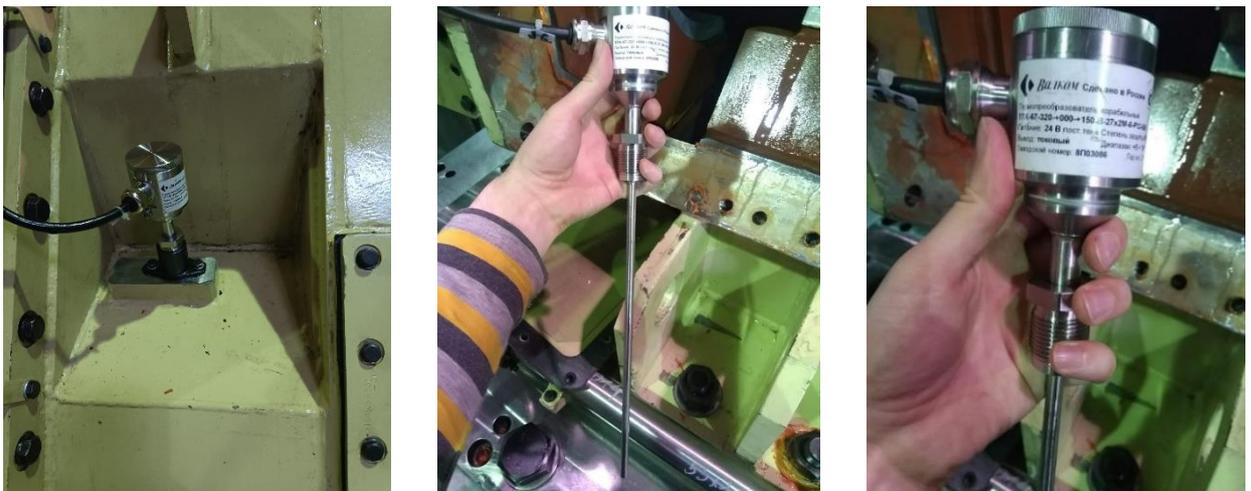
Рисунок 3.5 – Контроль температуры в подшипниковом узле с помощью установки термопреобразователя ТПК-67-320 в корпус подшипника (фото автора)
