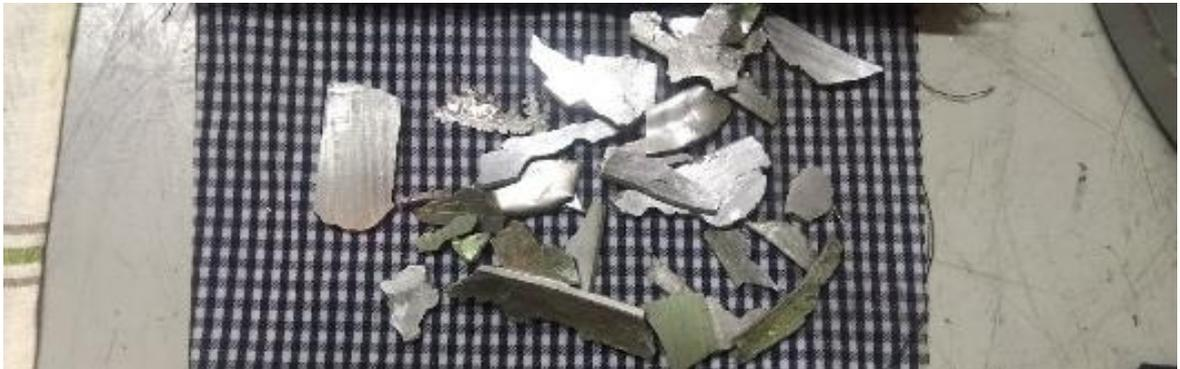
Рисунок 3.16 – Разрушение баббитового слоя вкладыша подшипникового узла при его испытании под нагрузкой по выражению (3.1) и изменению температуры в узле по выражению (3.5) (фото автора)
