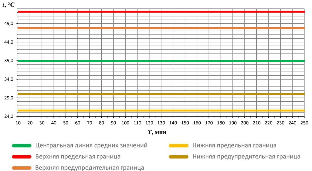
Рисунок 4.1 – Расчетная контрольная карта Шухарта средних значений для мониторинга температуры в опорном баббитовом гидростатическом подшипнике скольжения в процессе экспликации при удельной нагрузке на узел 3,3 МПа (составлено автором)
