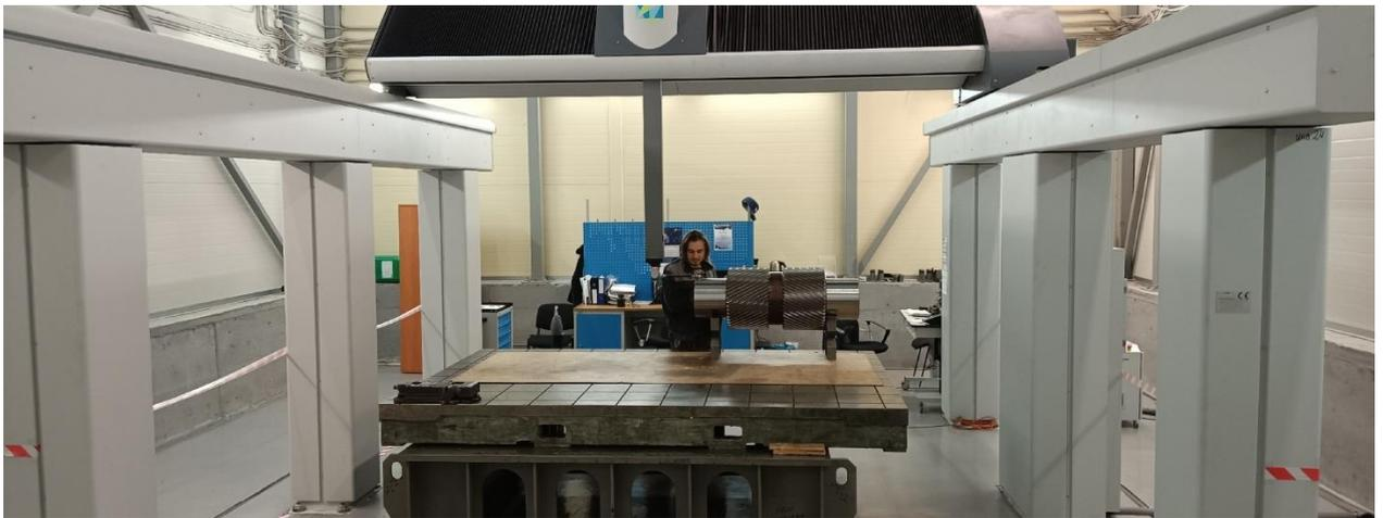
Рисунок 3.2 – Измерение геометрических параметров испытываемых цапф на КИМ Dea Delta мод. PERFORMANCE типоразмера 35.51.25 (фото автора)
