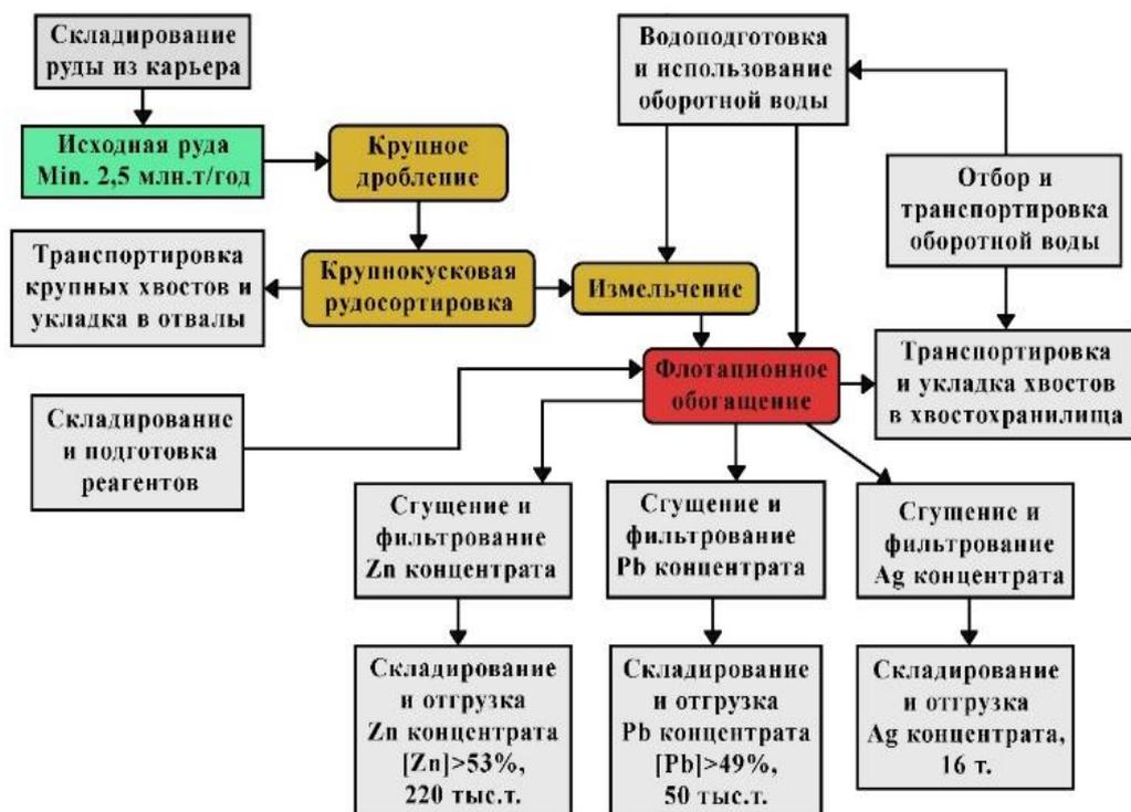
Рисунок 1.1 – Укрупненная технологическая схема переработки серебряносодержащих свинцово-цинковых руд месторождения «Павловское» (составлено автором)
