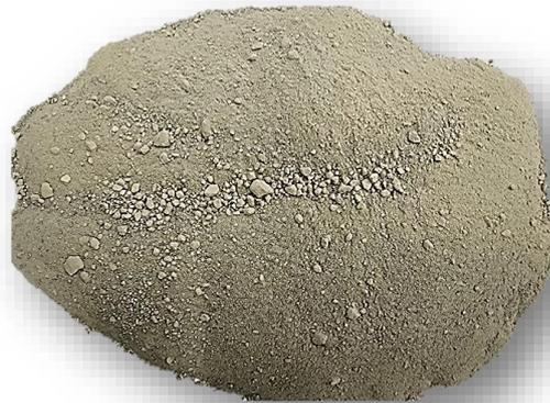
Рисунок 4.3 – Техногрунт, полученный на основе литификации фильтрата полигонов ТКО доменным шлаком
