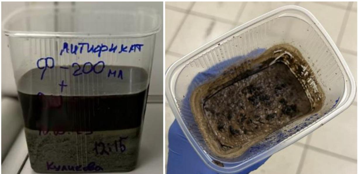
Рис. 3.10 – Литификат в массовом соотношении 1 : 0,67 фильтрата и доменного шлака: (а) – день приготовления смеси; (б) – 21 день твердения смеси
