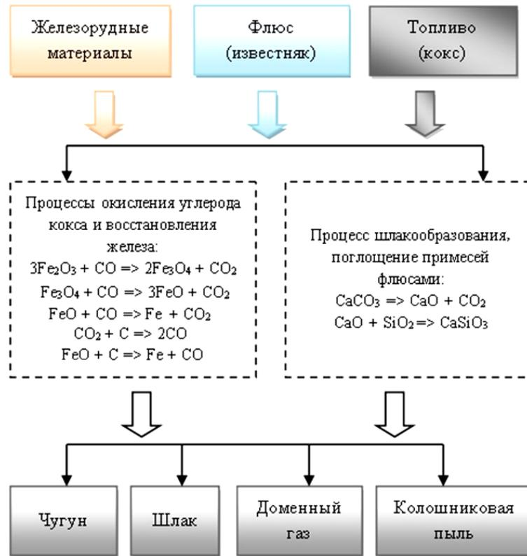
Рисунок 1.5 – Химический процесс образования чугуна и доменного шлака
