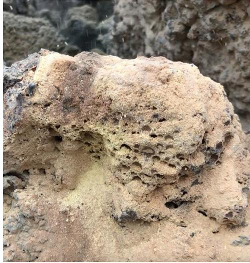
Рисунок 2.7 – Растрескивание шлака при силикатном распаде
